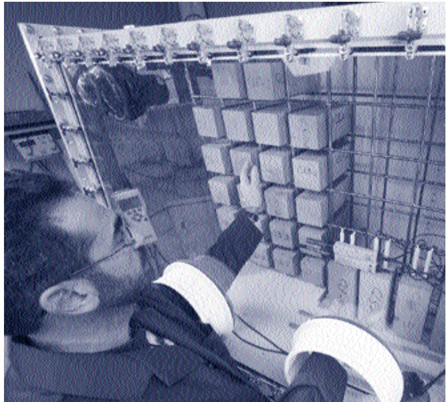
*Dans cette machine pour essai de carbonatation accéléré, des prismes de béton sont exposés à 65 % d'humidité et à 3 % de CO<sub>2</sub> à une température de 23 °C pour accélérer la diffusion du CO<sub>2</sub> dans le béton. À divers intervalles de temps, une tranche est sciée des prismes de béton et enduite d'un jet d'indicateur à la phénolphthaléine. La zone non colorée indique la profondeur de la carbonatation.*
