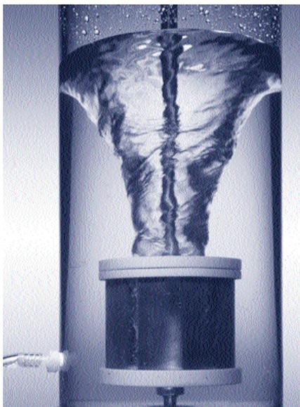
*La cage rotative aide à sélectionner les inhibiteurs de corrosion pour les pipelines de production et de transport du pétrole et du gaz et les raffineries de pétrole. Elle peut aussi servir à sélectionner des matériaux pour des conduites et des raccorderies et à évaluer les effets du débit sur la corrosivité de liquides.*
