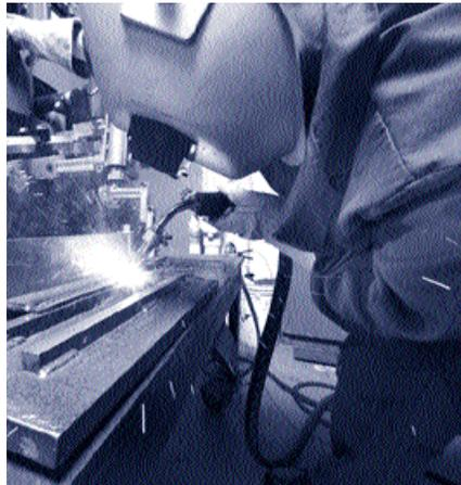
*Un technicien en soudage du LTM-CANMET effectue un soudage MIG (protection gazeuse inerte) expérimental afin d'établir les conditions optimales de la production de soudures par recouvrement dans les aciers de pointe à haute résistance.*
