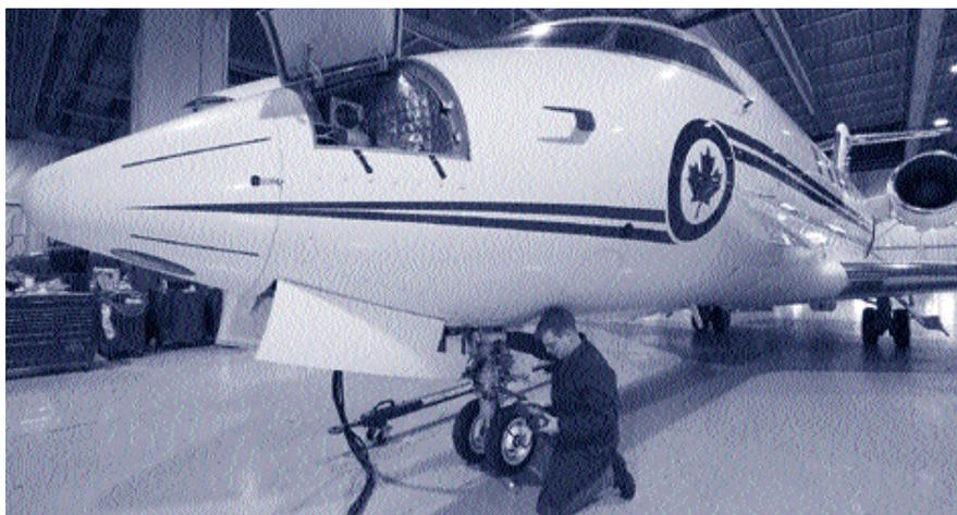
*Un technicien en essais non destructifs procède à une inspection aux ultrasons pour déterminer s'il y a des fissures autour des trous forés pour l'installation des boulons dans le train d'atterrissage d'un Challenger CC144. Le même essai peut être effectué sur diverses pièces et composants de l'avion.*
