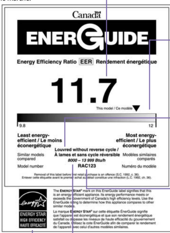
L'échelle montre l'écart des EER des modèles de même type et de même capacité vendus au Canada.
