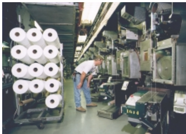
Gord Blenderman, technicien de filature à l'usine de Kingston, vérifie le fonctionnement du tambour rotatif à grande vitesse servant à la filature de fil en nylon.
