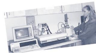
*Granulomètre laser pour les particules entre 1 mm et 2 micromètres*
