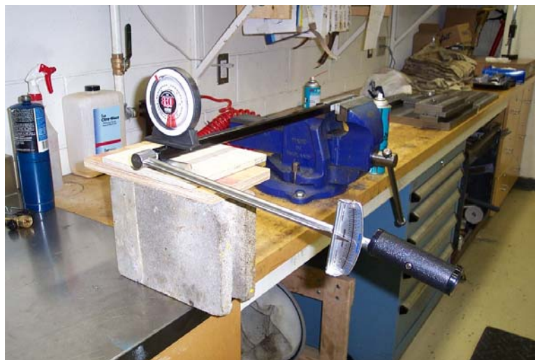
Figure 14 : Montage de la mesure de la rigidité d'une barre de torsion.
