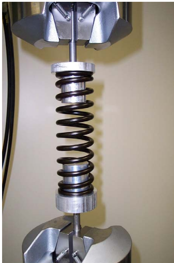
Figure 11: Montage d'un ressort sur les mors d'une machine servo-hydraulique.
