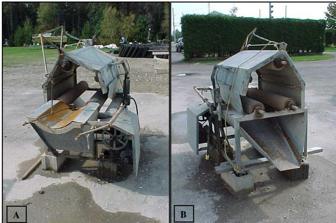
**Figure 20 : Détriqueuse (A - Entrée du collecteur B - Sortie des huîtres)**
