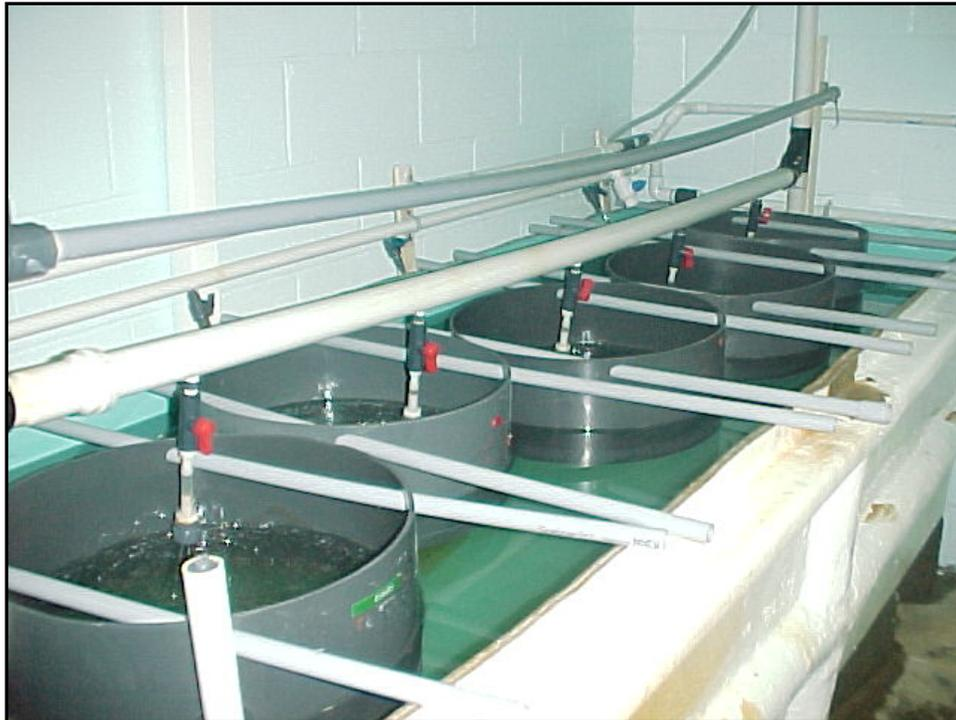
**Figure 17 : Système de «Downweller» utilisé en écloserie**
