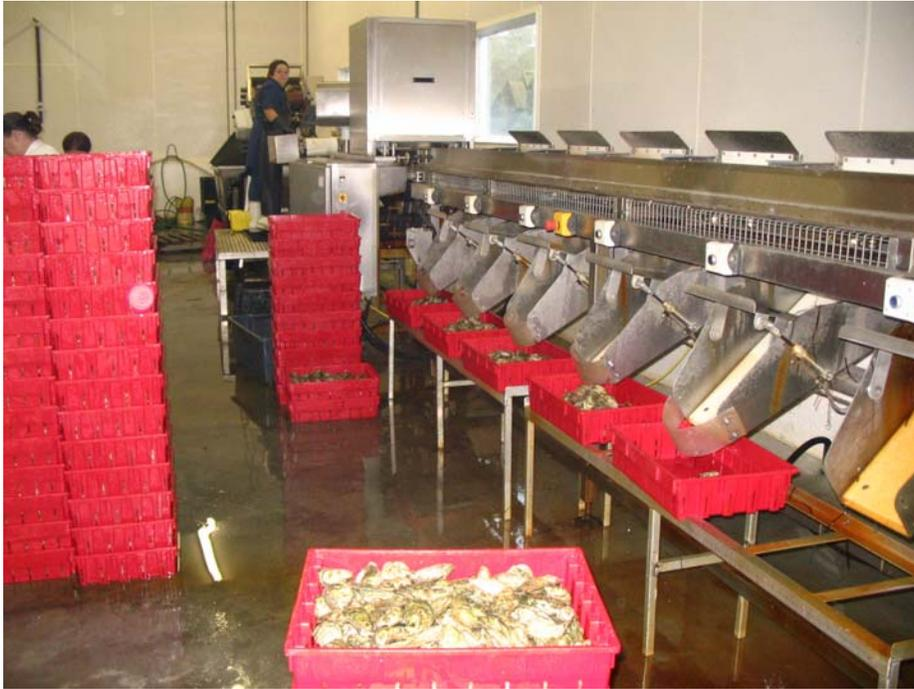
**Figure 44 : Vue latérale d'une calibreuse d'huîtres**
