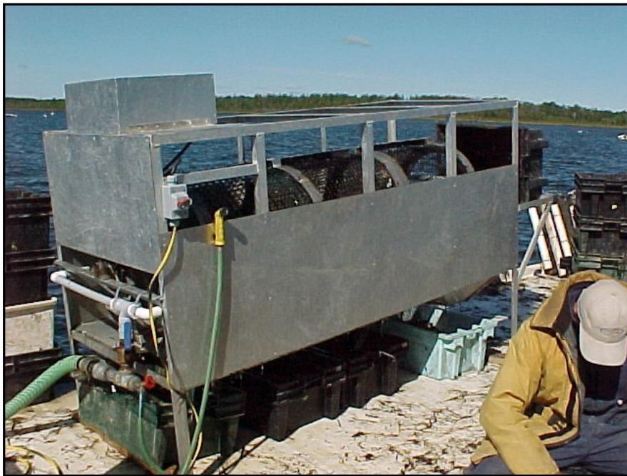
**Figure 28 : Trieuse d'huîtres (fabrication artisanale)**
