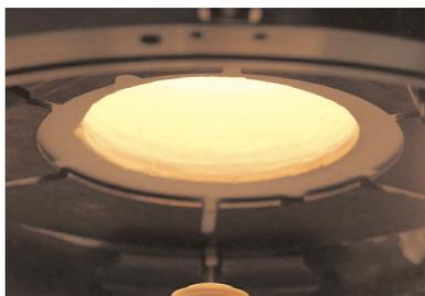
Des produits en céramique tels que les disques de frein, les isolateurs et les bridges dentaires sont produits par agglomération - formation de poudres puis cuits dans des fours. Bien entendu, il est crucial de savoir exactement combien de temps et à quelles températures les produit doivent être cuits.
