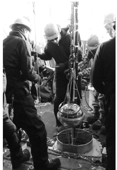
Figure 3 Travailleurs de Ice Cube abaissant la chaîne et le module du détecteur.
