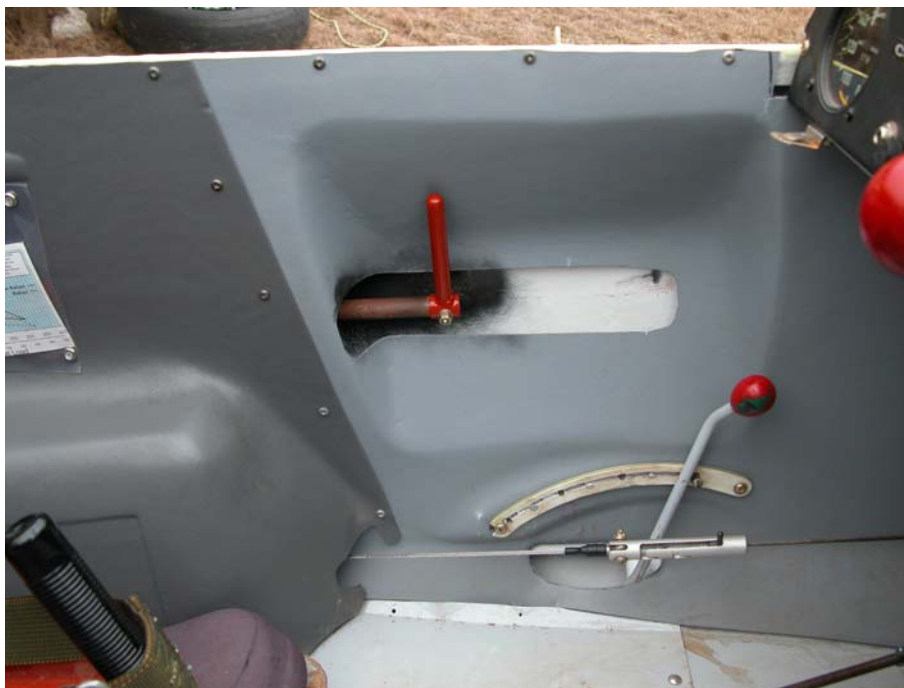
Photo 8 : Position des commandes des déporteurs et du compensateur
