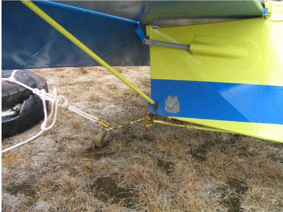
Photo 5 : Fixation de la lame de queue endommagée
