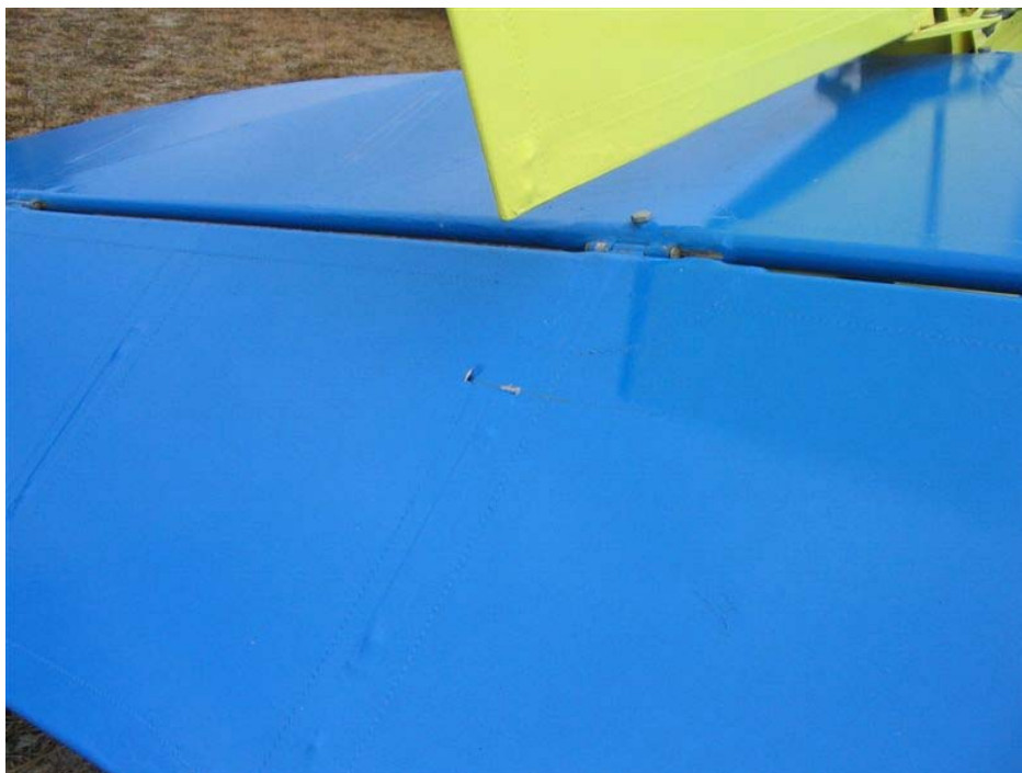
Photo 6 : Contact entre le gouvernail de direction et la gouverne de profondeur
