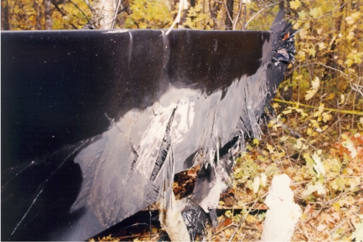
Photo 7 - Site 2 - Burnt Rear Rotor Blade// Secteur 2 : pale du rotor arrière brûlée
