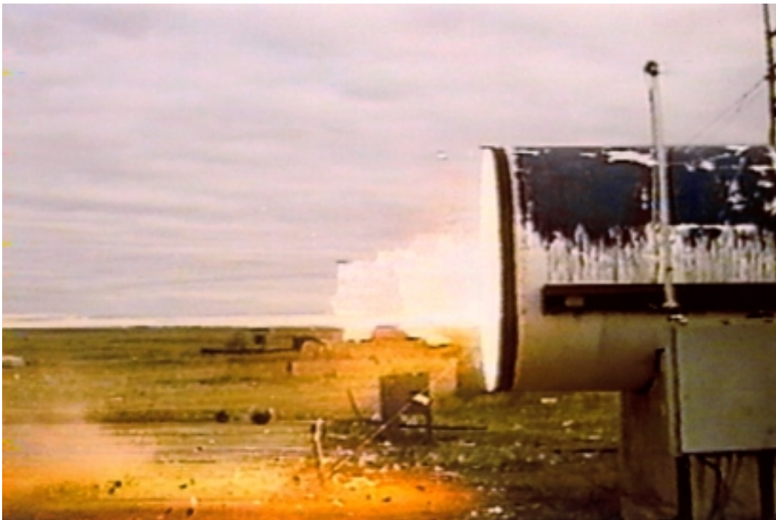
Photo 45 - DRES Engine Door Blast Experiment - Note flame emerge from structure (possible ignition source for fuels exterior of structure through vents) // Expérience du CRDS portant sur l'ouverture de la porte d'accès au moteur lors d'une explosion; remarquez la flamme qui sort de la structure (source d'allumage possible du carburant rejeté à l'extérieur de la structure par des mises à l'air libre)
