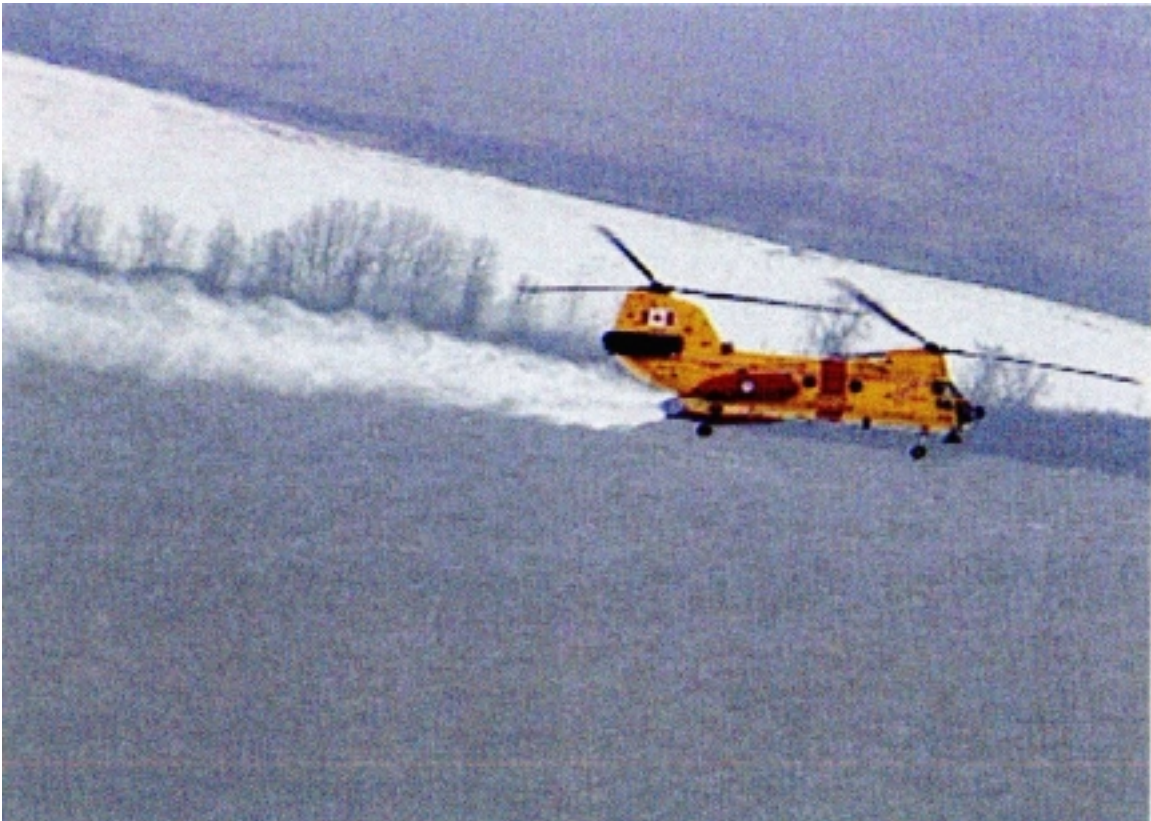
Photo 22 - CH113 Dumping Fuel - Side view (note dump tubes extended and close fuselage to fuel distance)// - Largage de carburant par un CH113 – vue latérale (remarquez l'extension des tubes du vide-vite et la proximité du carburant et du fuselage)
