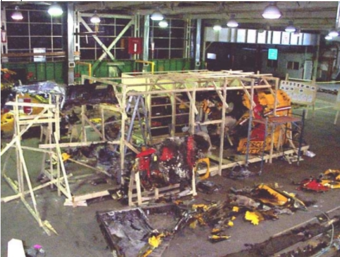
Photo 18 - Rebuild of Ch11305 - Right side// Reconstitution du CH11305 : côté droit
