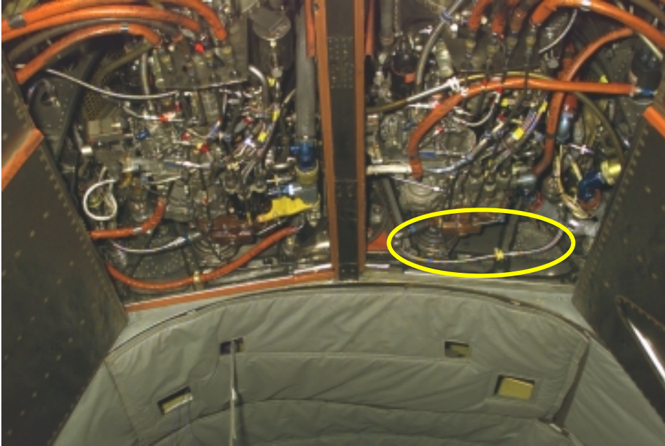
Photo 36 - Normal CH113 Engine Configuration looking from rear ramp forward and up (#2 Engine on right)(Main Fuel Supply Line circled) // Configuration normale d'un moteur de CH113 depuis la rampe arrière, en position avant et relevée (moteur numéro 2 à droite) (la conduite principale d'alimentation en carburant est encerclée)
