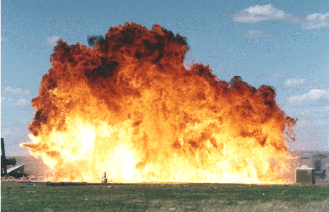
Photo 52 - DRES Experiment igniting simulated fuel dump cloud// – Expérience du CRDS visant à enflammer le nuage de carburant simulé à la suite d'un largage
