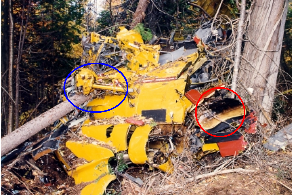
Photo 9 - Site 1 - Top and right side of Fuselage, Rescue Hoist (blue) - note the small fuselage burn top of Sync Shaft Tunnel area (red)// Secteur 1 : haut et côté droit du fuselage, treuil de sauvetage (en bleu) – remarquez la partie brûlée du fuselage en haut du tunnel de l'arbre de synchronisation (en rouge)
