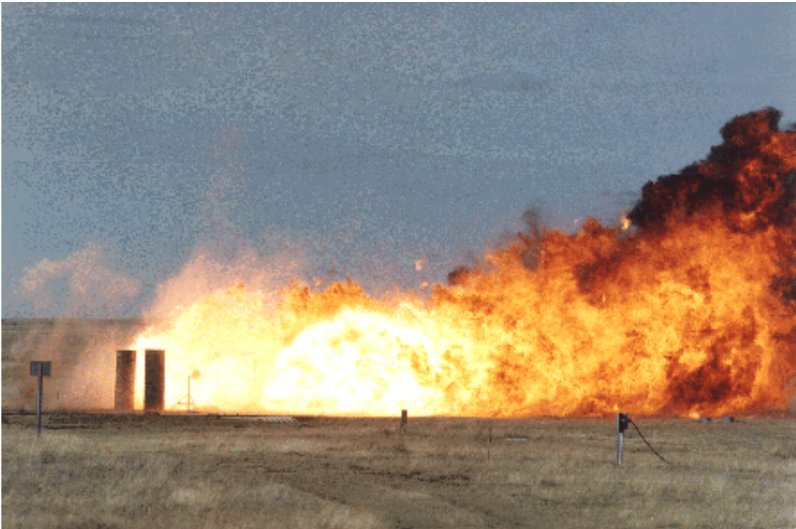
Photo 52 - DRES Experiment igniting simulated fuel dump cloud// – Expérience du CRDS visant à enflammer le nuage de carburant simulé à la suite d'un largage
