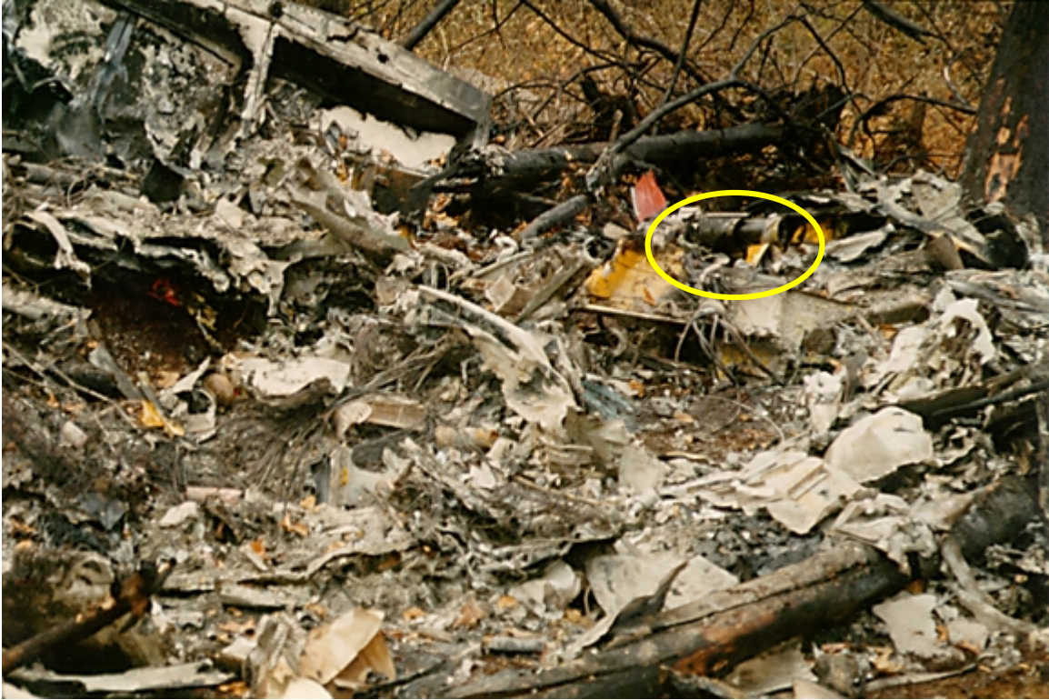
Photo 25 - Left Dump Tube as found on day 3 (retracted and circled)// Tube gauche du vide-vite tel qu'il était lorsqu'on l'a retrouvé au jour 3 des recherches (rentré et encerclé)
