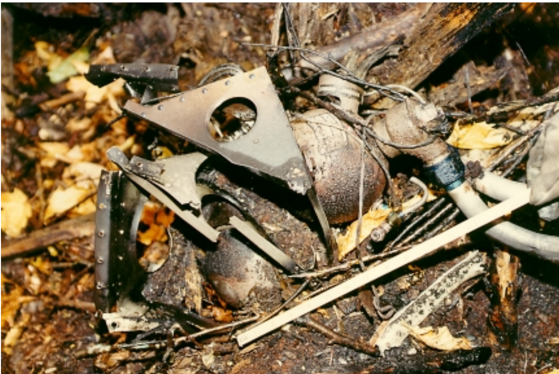
Photo 33 - Fire Extinguisher Bottles// Extincteurs
