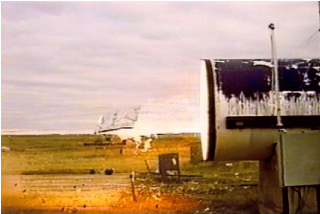
Photo 44 - DRES Engine Door Blast Experiment - Note simulated blast door exiting structure // Expérience du CRDS portant sur l'ouverture de la porte d'accès au moteur lors d'une explosion; remarquez la reproduction de la porte qui est projetée hors de la structure
