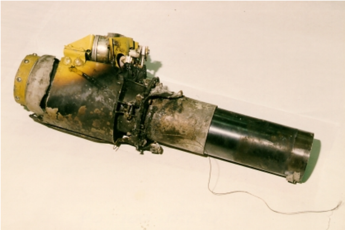
Photo 48 - Left Hand Dump Tube (extended and confirmed)// Tube gauche du vide-vite (sorti et confirmé)
