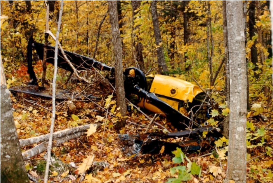
Photo 6 - Site 2 Rear Pylon and Rear Rotor blades (note undamaged surrounding trees)// Secteur 2 : pylône arrière et pales du rotor arrière (remarquez les arbres intacts)
