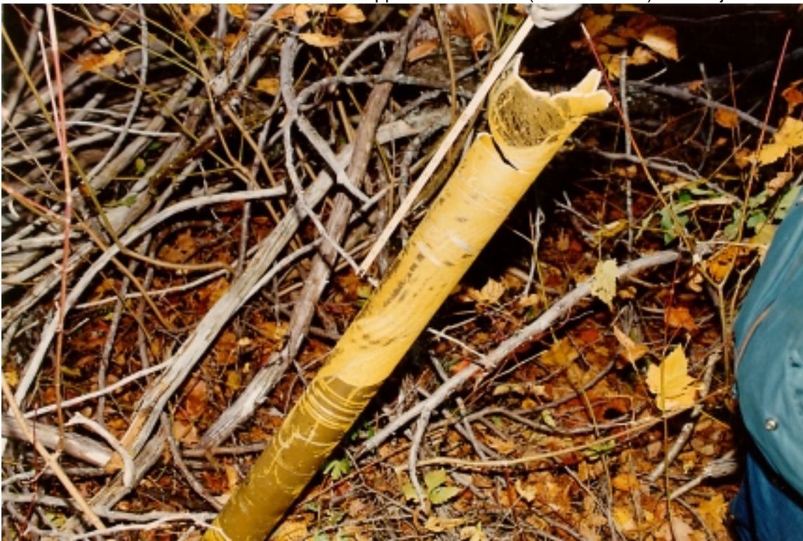
Photo 13 - Sync Shaft Fragment - Upper Debris field//– Morceau de l'arbre de synchronisation récupéré dans le secteur supérieur
