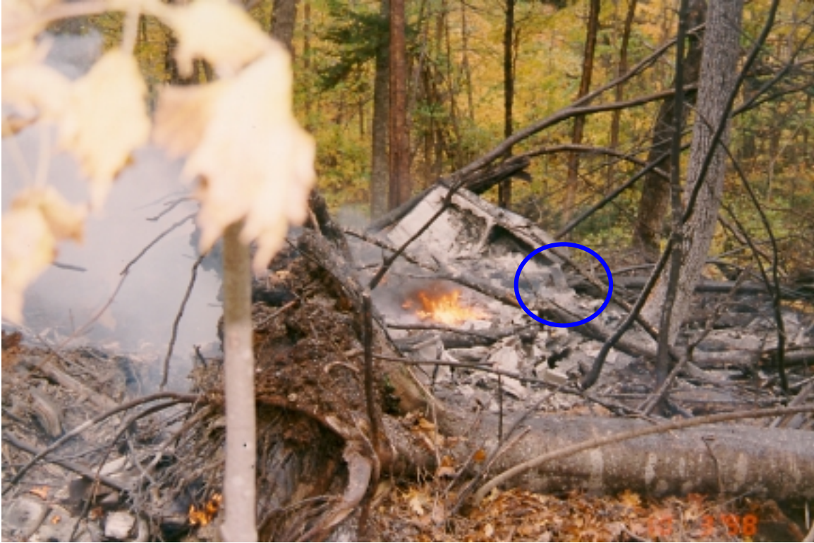
Photo 23 - Left Dump Tube (extended and circled) in post-crash fire// Tube gauche du vide-vite (en extension et encerclé) lors de l'incendie ultérieur à l'écrasement
