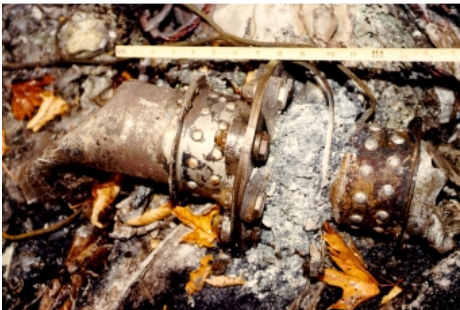
Photo 29 - Thomas Coupling and melted Sync shaft sections// Raccordement de Thomas et sections fondues de l'arbre de synchronisation.
