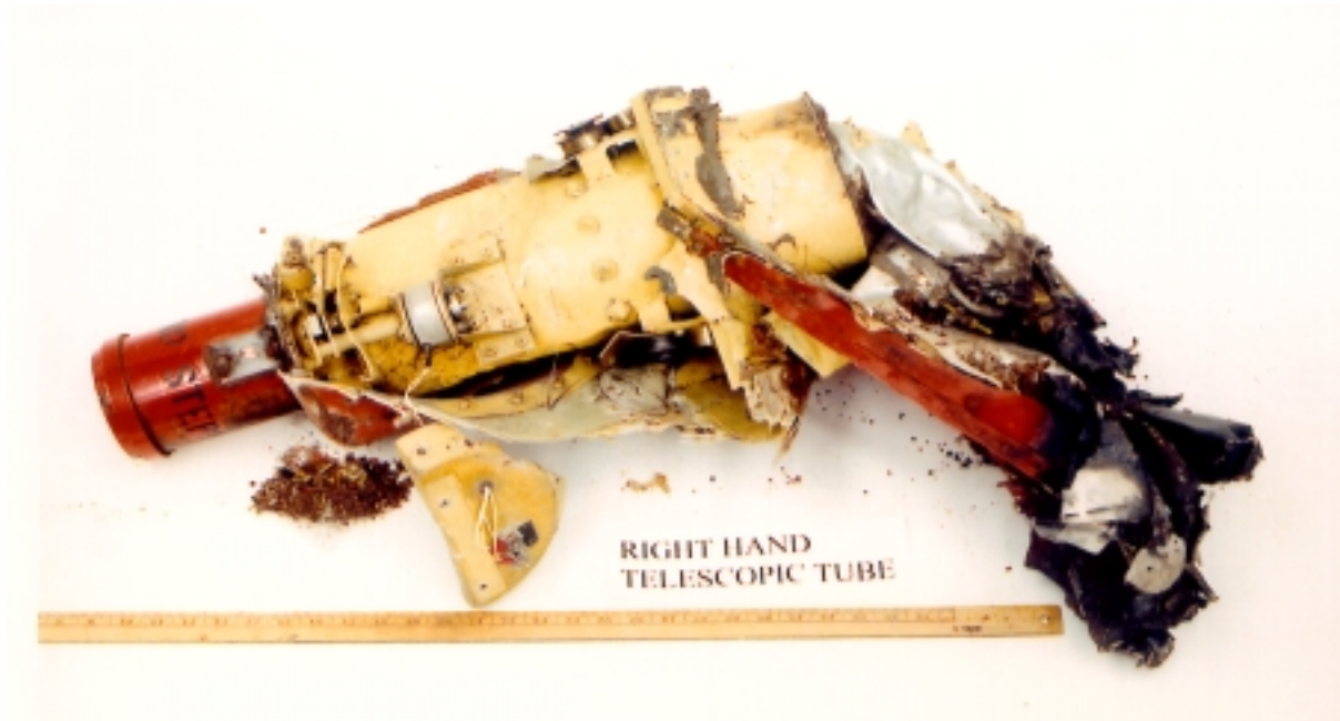
Photo 46 - Right Hand Fuel Dump Tube (retracted and confirmed)// Tube droit du vide-vite (rentré et confirmé)
