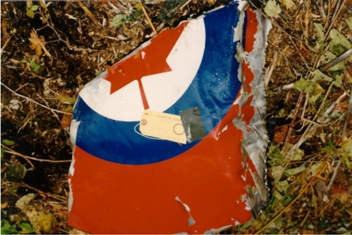
Photo 56 - Section of Left Stub Wing Fuel Tank - Note High Energy Impact created folds on right and no fire damage// Section du réservoir de carburant du moignon d'aile gauche; remarquez que la force de l'impact a plié la partie droite du réservoir et que le feu ne l'a pas endommagée
