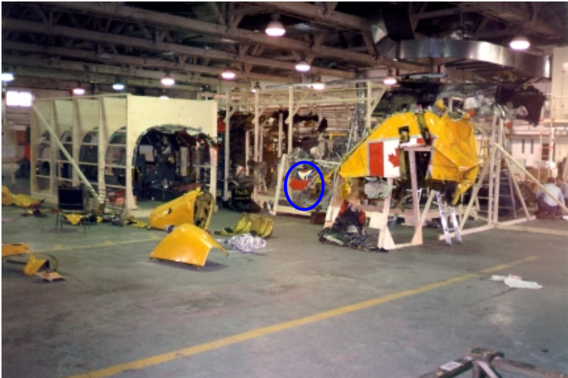
Photo 57 - Rebuild Facility showing Left Stub Wing Fuel Tank Section (circled)// Installation où l'on a procédé à la reconstitution et réservoir de carburant du moignon d'aile gauche (encerclé)
