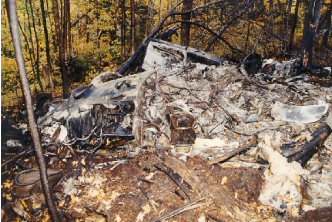
Photo 5 - Site 3 - Aft Fuselage, Engines and MGB// Secteur 3 : fuselage arrière, moteurs et boîte de transmission principale
