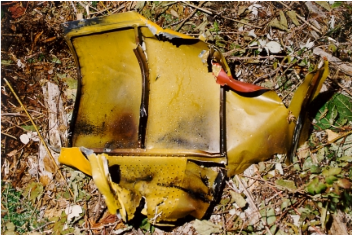
Photo 11 - Debris in Upper Field - Sync Shaft Tunnel Cover// Débris récupérés dans le secteur supérieur : carter du tunnel de l'arbre de synchronisation
