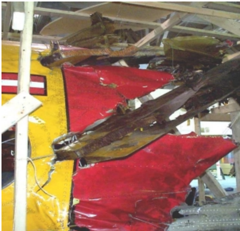
Photo 16 - Blade Pieces Inserted in Fuselage (confirming only 2 blades made all 4 cuts in fuselage).// Morceaux de pales enfoncés dans le fuselage (confirmant que les quatre entailles dans le fuselage sont attribuables à deux pales).
