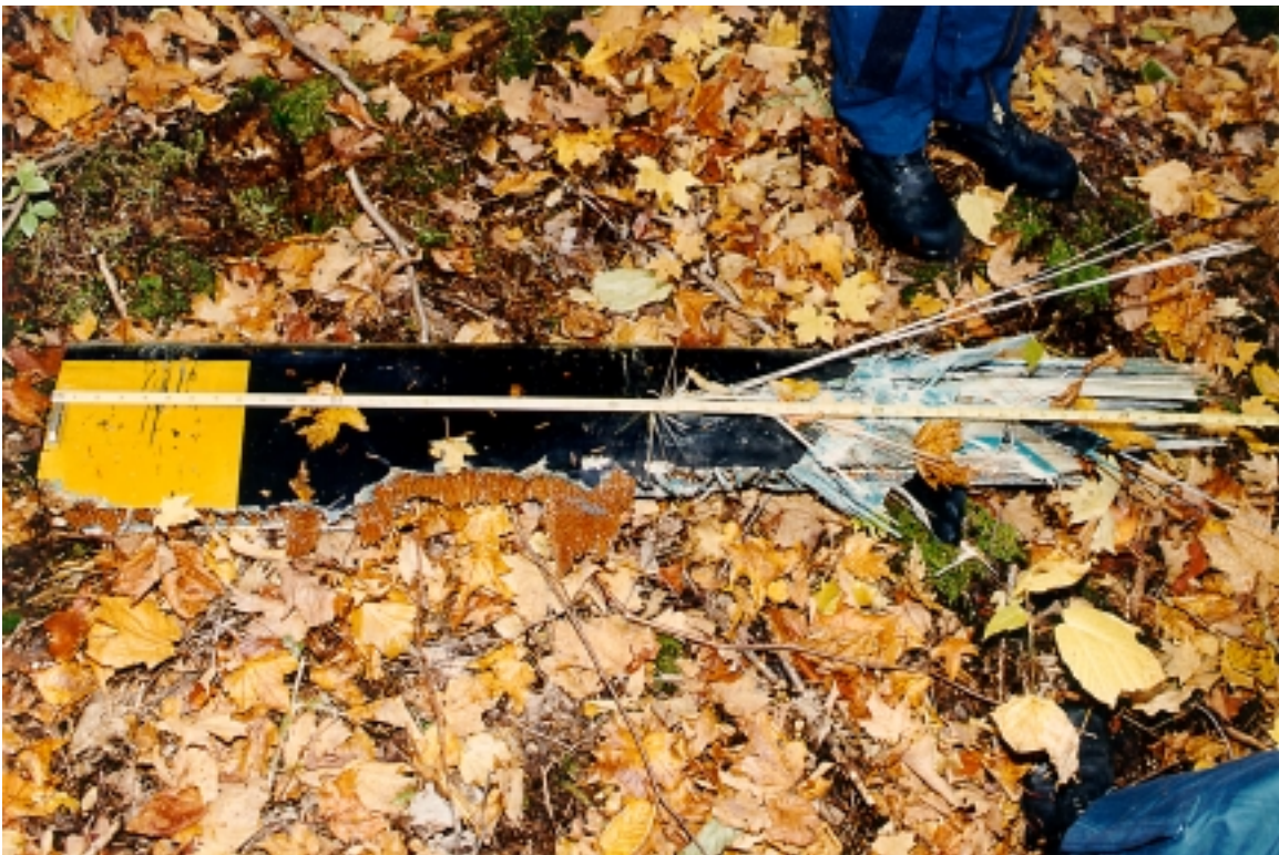
Photo 26 - Rear Rotor Red Blade Fragment - Note the unburned and frayed ends// Fragment de la pale rouge du rotor arrière; remarquez les bouts, non brûlés et « effilochés »
