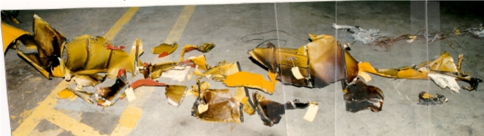
Photo 28 - Sync Shaft Tunnel Cover re-build (interior)(note soot on interior right side)// Reconstitution du carter du tunnel de l'arbre de synchronisation (intérieur) (remarquez la suie à l'intérieur, sur le côté droit)
