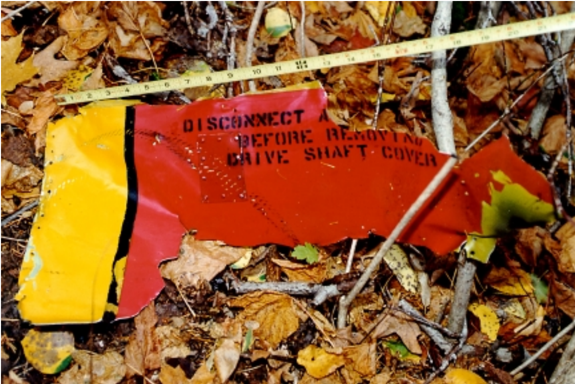
Photo 11 - Debris in Upper Field - Sync Shaft Tunnel Cover// Débris récupérés dans le secteur supérieur : carter du tunnel de l'arbre de synchronisation
