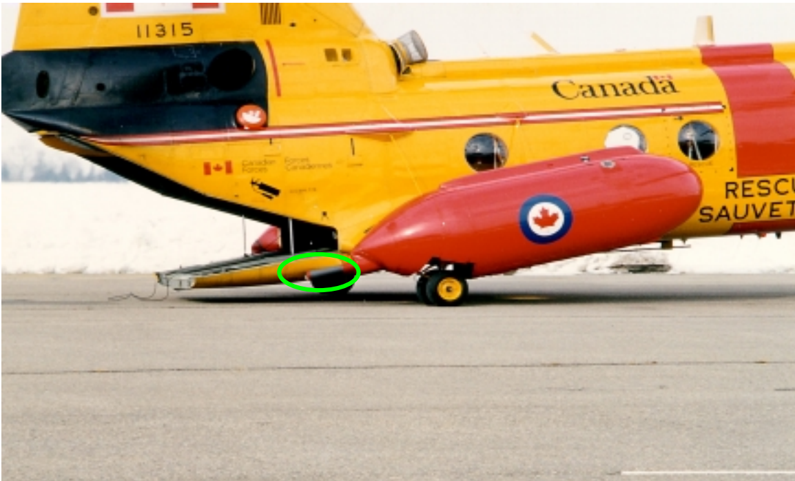
Photo 49 - CH113 with Fuel Dump Tubes Extended (circled)// Tubes du vide-vite sortis sur un CH113 (encerclés)
