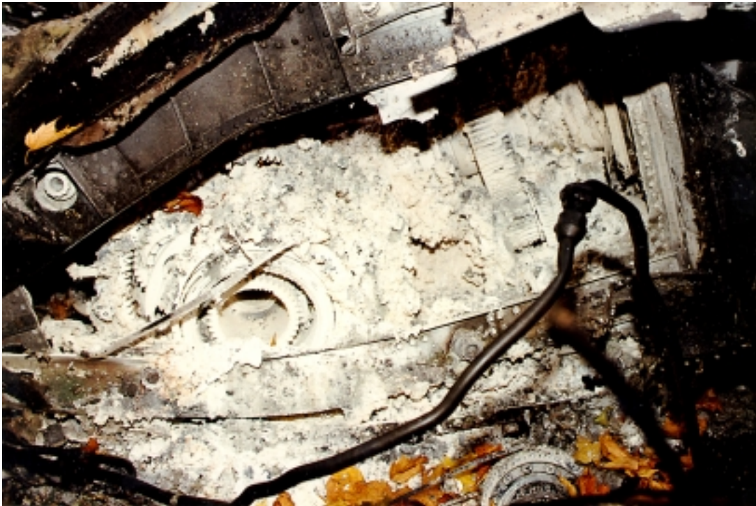
Photo 17 - MGB Gears and Ash of Outer Casing// Engrenages de la boîte de transmission principale et cendres du carter extérieur
