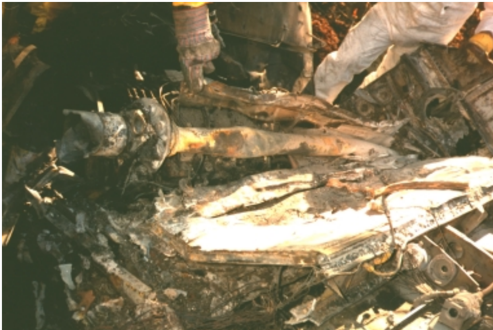
Photo 39 - Engine Compartment (steel) Sync Shaft - Note discoloration due to heat (Number 1 engine door in foreground) // Compartiment moteur (acier) et arbre de synchronisation; remarquez la décoloration imputable à la chaleur (porte d'accès au moteur numéro 1 en avant-plan)
