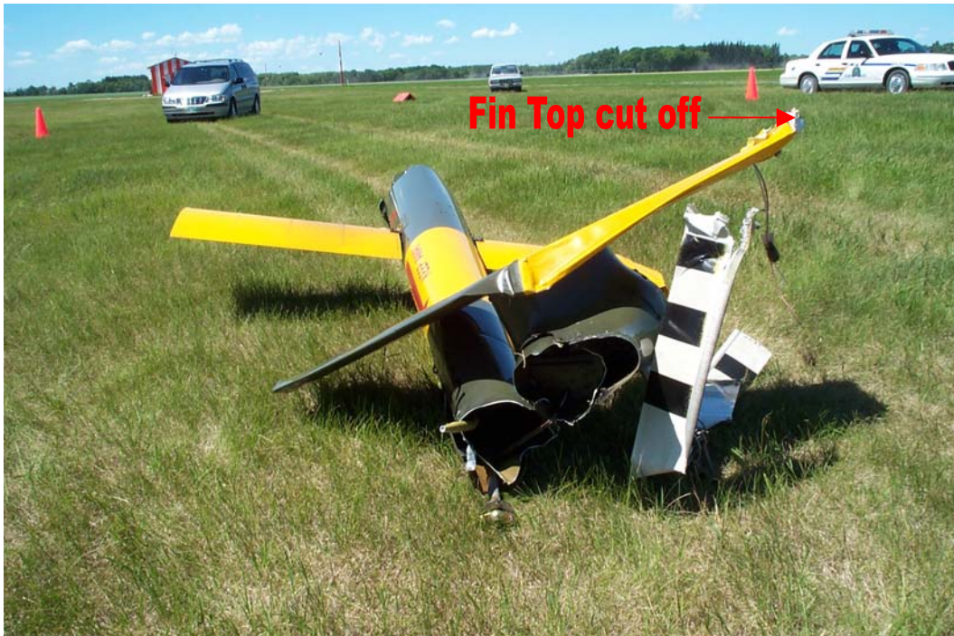
Photo 6: Tail Boom – Tail fin damage Poutre de queue – Dommages subis par la dérive
