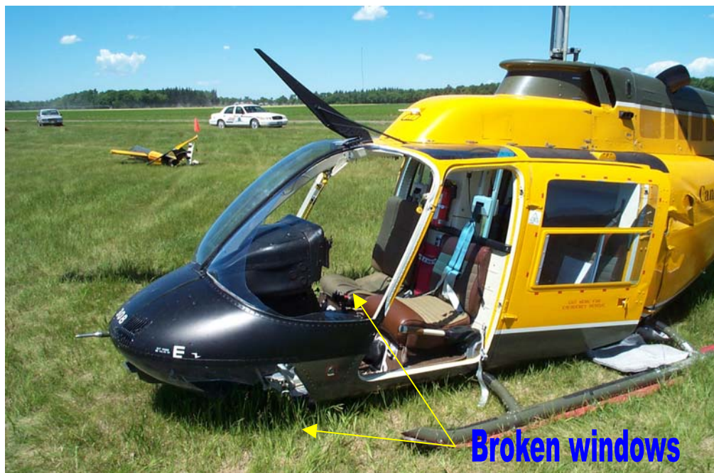
Photo 4: Wreckage – Port Side View (Doors removed by emergency crews) Épave – Vue latérale gauche (Portes retirées par les membres de l'équipe de secours)
