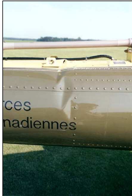
Photo 1: Tail boom – starboard side buckling Poutre de queue – gauchissement côté droit
