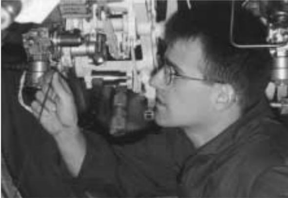
Le soldat Dickie s'est vu confier la vérification périodique FOD (dommages causés par corps étrangers) de l'Aurora CP140119. En effectuant cette vérification, le soldat Dickie a remarqué quelque chose d'anormal concernant le parcours des câbles de commande des systèmes de contrôle des commandes de vol principales et secondaires des gouvernes de direction et de profondeur. Une inspection
