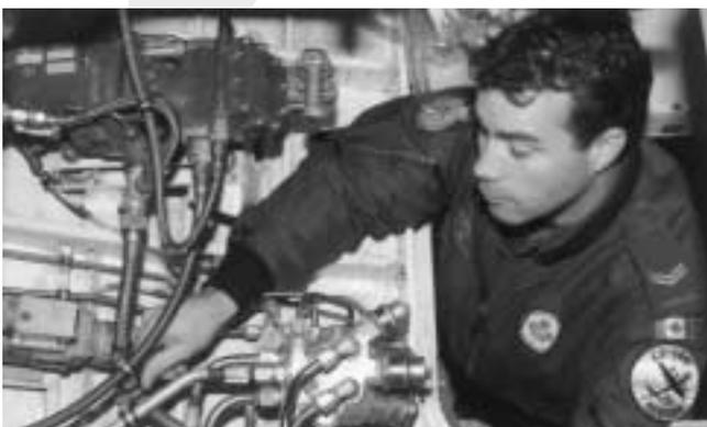
Pendant qu'il faisait une inspection pré-vol à bord d'un avion Aurora, le Caporal Harper a repéré quelque chose d'anormal dans le cheminement d'une conduite hydraulique tressée. Il s'est immédiatement laissé descendre dans le compartiment hydraulique afin de repérer l'origine du problème. En examinant les choses de plus près, il a
