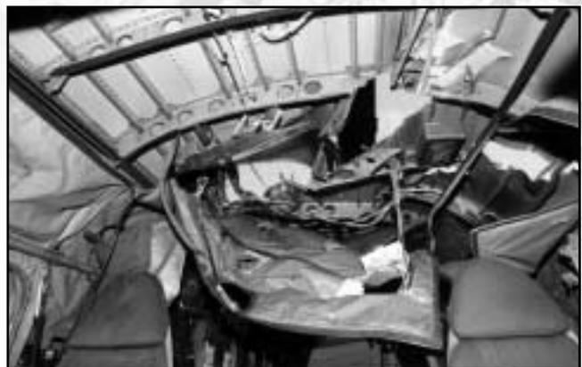
et les pales du rotor avant qui tournaient en roue libre ont été endommagées lorsqu'elles ont percuté la pale du rotor arrière qui s'était logée dans le toit de l'hélicoptère. Le moignon d'aile gauche a été enfoncé par une des pales du rotor arrière qui avait subi des dommages, mais le réservoir de carburant n'a pas été perforé.
