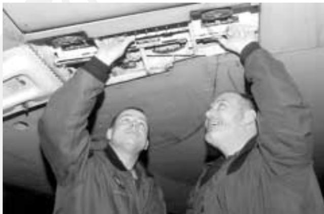
En décembre 2001, le caporal Billard procédait au ravitaillement en carburant de l'Aurora numéro 140120 quand il a remarqué que la conduite de l'indicateur de surpression du réservoir numéro 5 frottait contre la biellette de commande des ailerons. Il a alors immédiatement repositionné la conduite de carburant de manière à ce qu'elle ne touche plus la biellette de commande.
