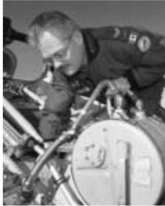
ces défauts cachés. Si personne n'avait découvert l'affaiblissement des supports du réservoir d'huile, ce dernier se serait sans doute déplacé sous l'effet des fortes vibrations inhérentes au fonctionnement des aéronefs à voilure tournante, ce qui aurait privé les deux moteurs de l'huile de lubrification essentielle.
