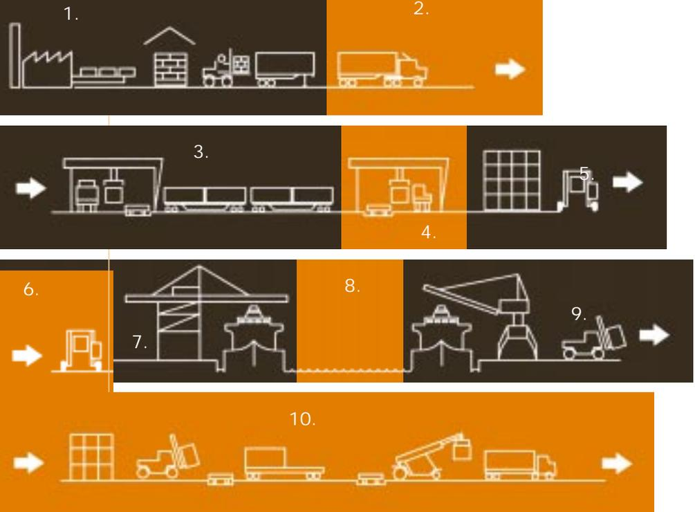
7. Le conteneur est saisi par un portique et amené jusqu'à une grue qui le soulève et le dépose dans le navire (déplacement, levage et remplacement).
