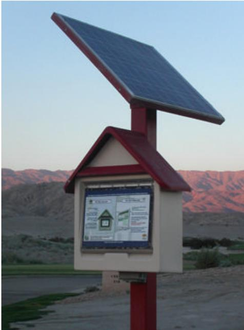
Chaque appareil TeePod est maintenant doté de son propre système d'alimentation à l'énergie solaire. Une pile de 12 volts est enfouie dans le sol près de chaque système et les composants sont alimentés directement par le courant continu fourni par la pile. Un panneau solaire de 70 watts recharge la pile à mesure que les composants l'épuisent. Le contrôleur qui
