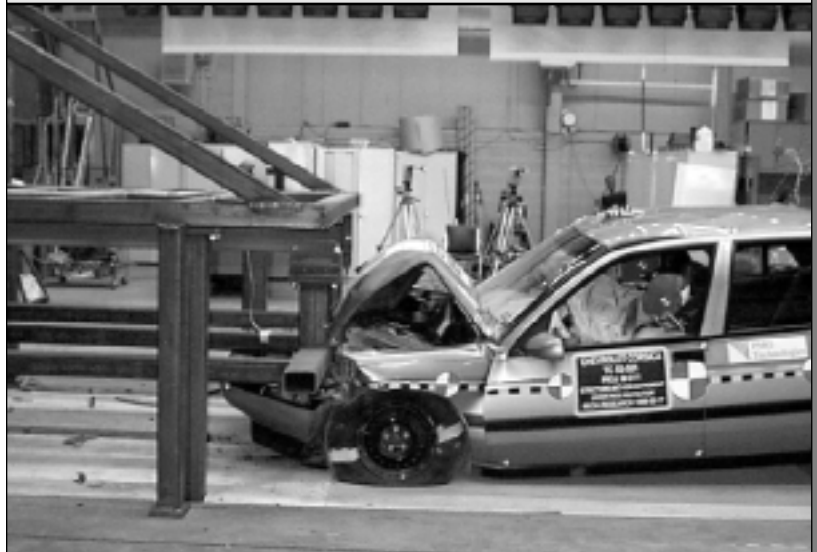
FIGURE 4-8 ÉTUDE DES EXIGENCES DE RENDEMENT D'UN DISPOSITIF ANTI-ENCASTREMENT
