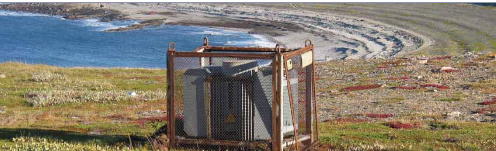
Des matières hautement radioactives qui pourraient être utilisées dans la fabrication d'une « bombe sale » alimentent à l'heure actuelle des phares russes. Photo : Gouverneur du comté de Finnmark (Norvège)
