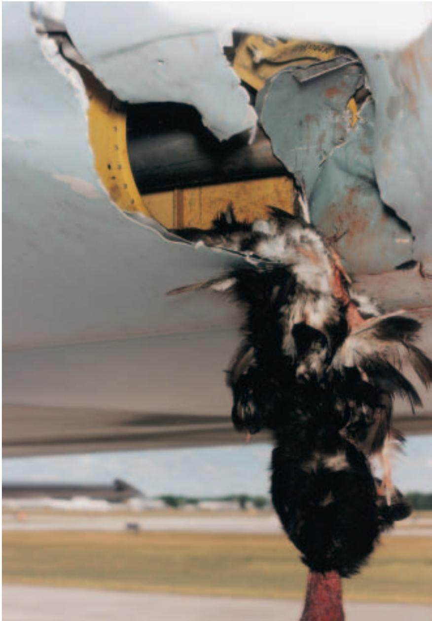
**Cliché 12** Des dommages importants aux composants de la cellule et aux dispositifs de bord d'attaque sont fréquents dans les cas d'impact d'oiseau. S'il y a pénétration des systèmes électriques et hydrauliques jusqu'au longeron, ils peuvent être endommagés.
