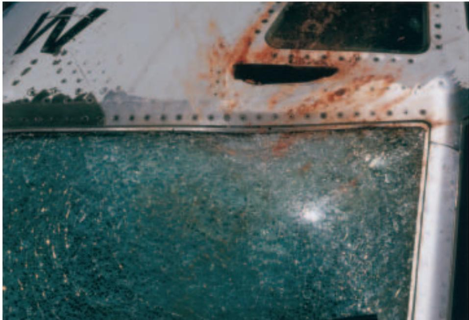
**Cliché 11** Le pare-brise de ce B737 a été gravement endommagé à la suite d'une collision avec un oiseau à 10 000 pieds ASL et 250 kts. Le commandant de bord a été blessé par des débris lorsque l'oiseau a fracassé le fuselage au-dessus du pare-brise.
