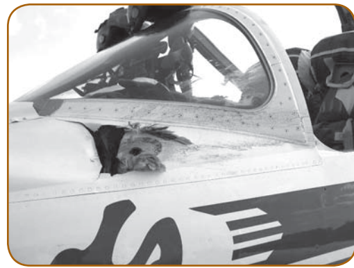
Dommages causés par un impact d'oiseau à un aéronef des Snowbirds.
