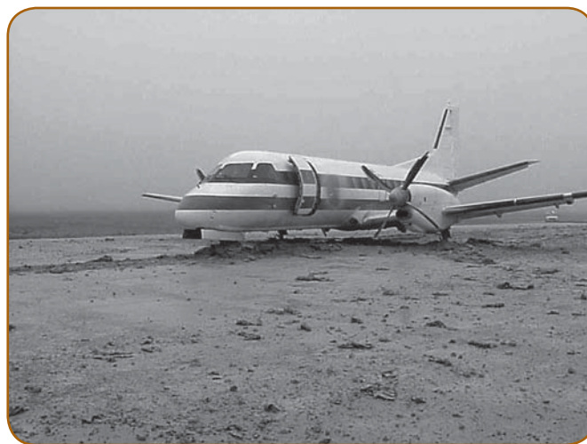
Exemple d'une sortie en bout de piste qui n'a pas résulté en un accident, grâce à un dispositif d'arrêt sur sol mou.
