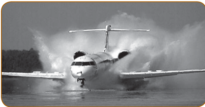
Essai d'ingestion d'eau d'un RJ 900.
