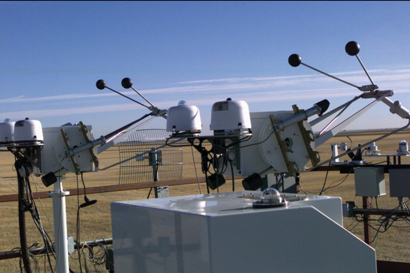
À l'observatoire de Bratt's Lake, le spectrophotomètre Brewer (au premier plan) mesure le rayonnement ultraviolet et l'épaisseur de la couche d'ozone, et les suiveurs solaires mesurent le rayonnement solaire diffus.
