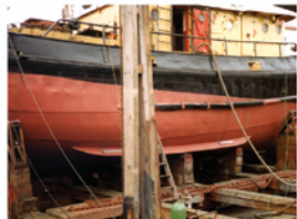
Pendant le décapage d'une surface revêtu de peinture antisalissure, il faut prendre des mesures de confinement adéquates pour éviter le déversement de substances nocives dans l'environnement.
