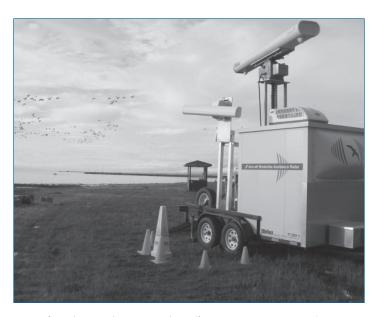
AGL (au-dessus du niveau du sol). Le système intègre la suite logicielle exclusive à DeTect de traitement de données radar, de cartographie du clutter, d'enregistrement de données (données radar brutes et traitées), d'affichage, de distribution et d'analyse qui a été mise au point spécifiquement pour la détection et la poursuite des caractéristiques uniques du comportement des oiseaux.
