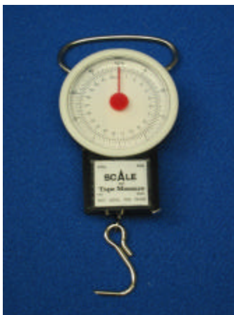
Figure 3. Méthode utilisée pour mesurer le relâchement de la ceinture de sécurité.
