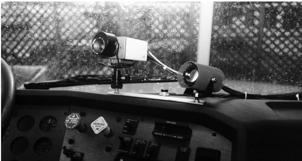
Figure 3. Caméra dirigée vers le conducteur et lampe infrarouge
