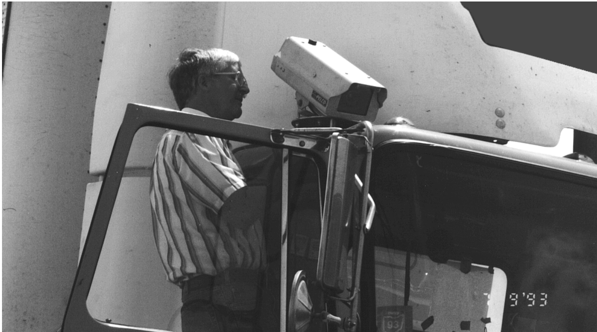
Figure 2. Appareil de mesure des déviations de trajectoires placé sur le pavillon du véhicule
