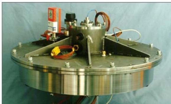
Figure 1 Système de stockage énergétique pour la stabilisation de l'orientation (ACES)
