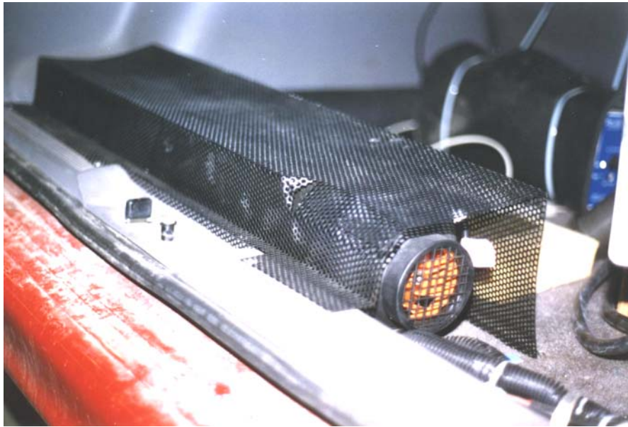
Figure 2.2 : Chaufferette diesel installée sous la grille de protection
