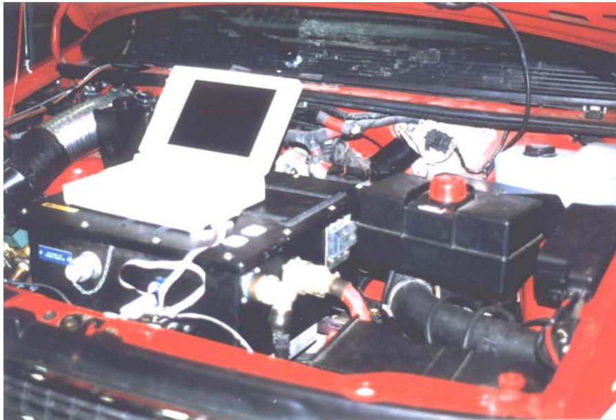
Figure 2.3 : Réservoir diesel installé sous le capot du véhicule
