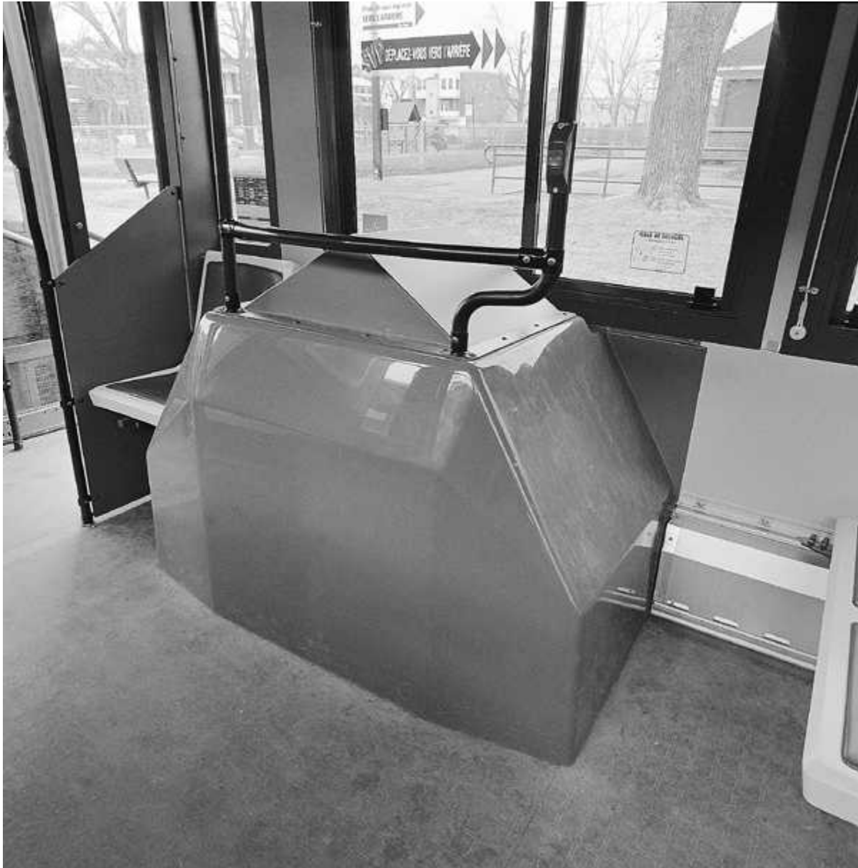
PHOTO II-11 - LOGEMENT DE ROUE RÉAMÉNAGÉ (NOVA LFS)
