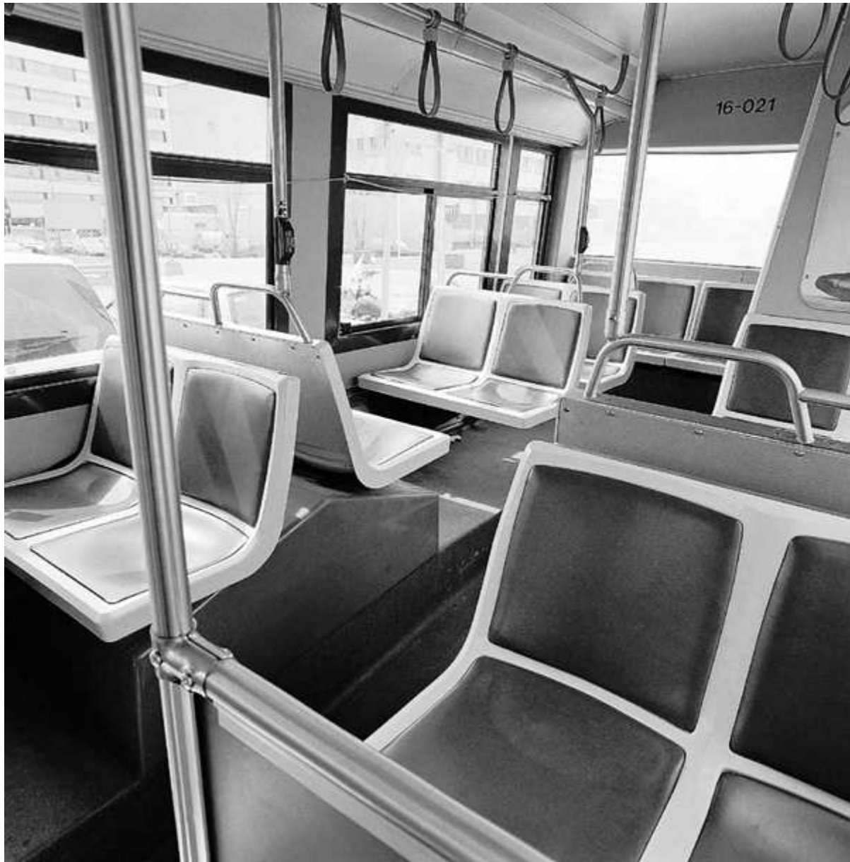
PHOTO II-14 - AMÉNAGEMENT D'ORIGINE DES SIÈGES DE LA PARTIE ARRIÈRE (NOVA LFS)
