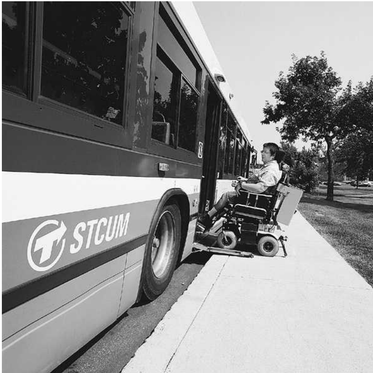
PHOTO II-16 - ACCÈS PAR LA RAMPE RÉTRACTABLE (NOVA LFS)
