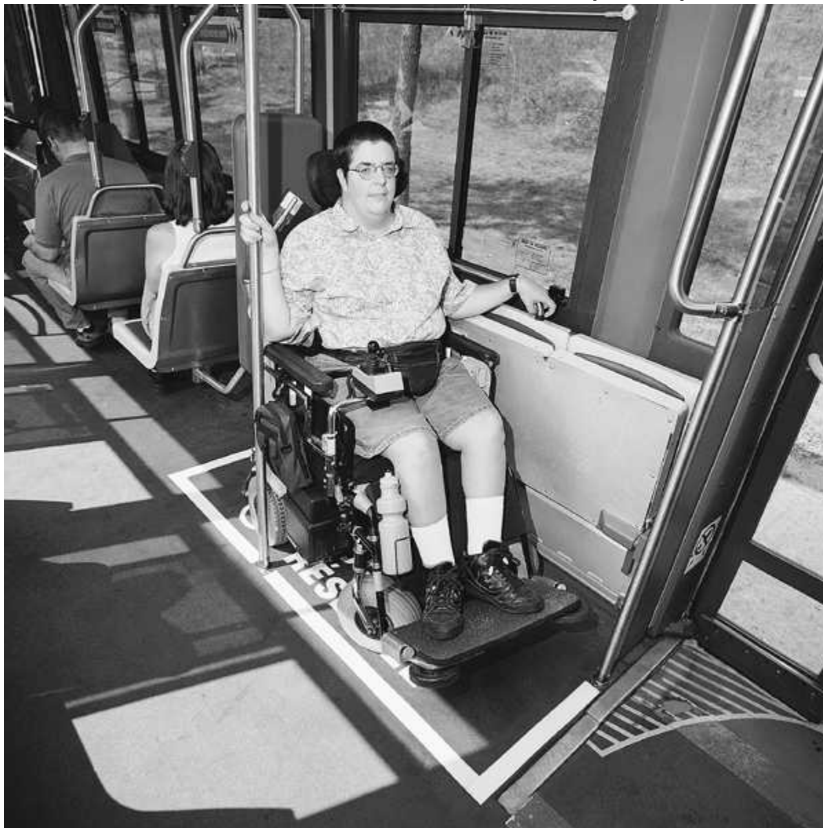
PHOTO II-17 - ESPACE POUR LE FAUTEUIL ROULANT (NOVA LFS)
