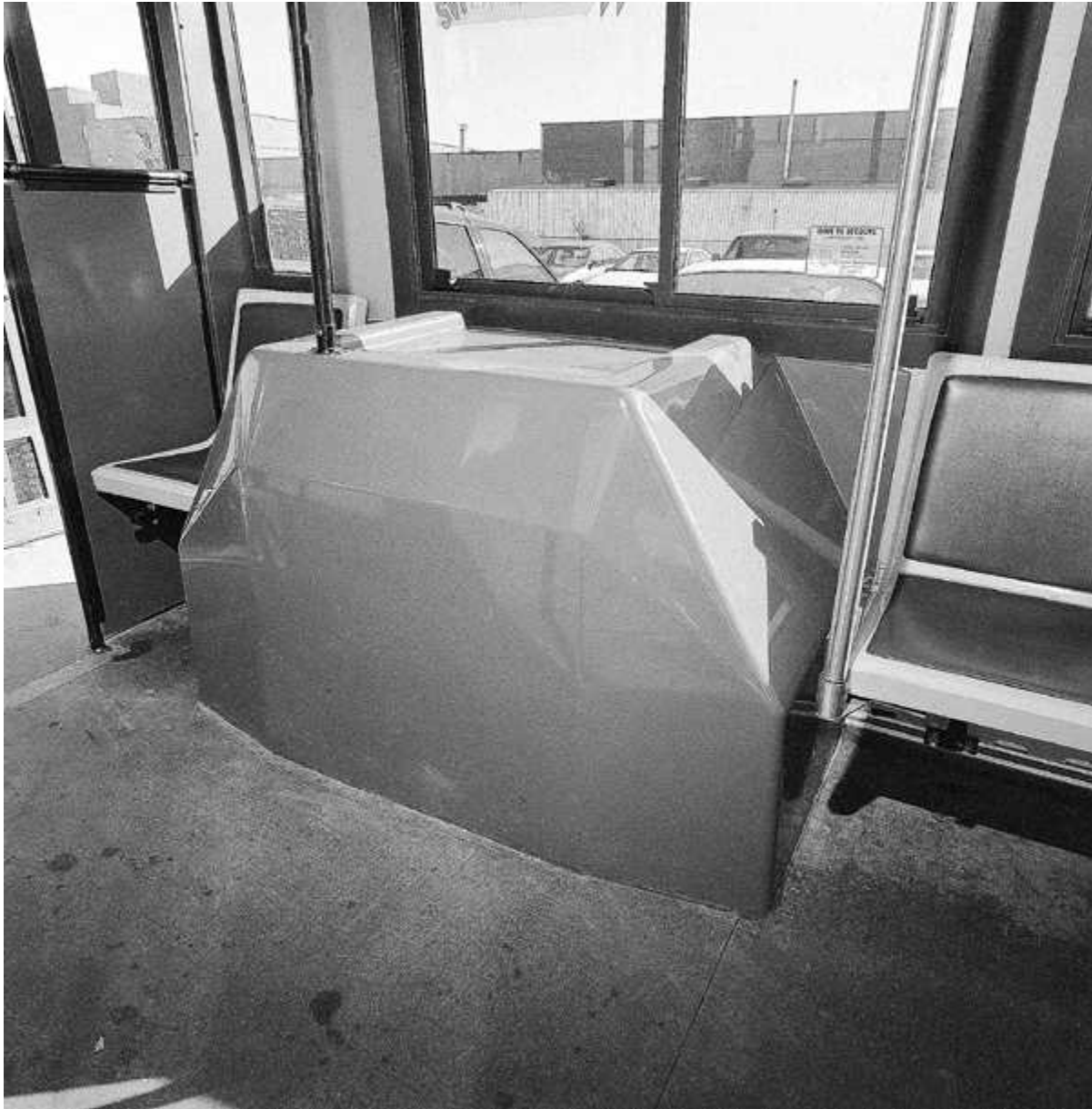
PHOTO II-10 - LOGEMENT DE ROUE D'ORIGINE (NOVA LFS)
