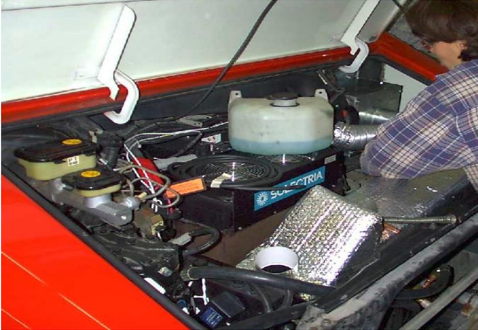
**Figure 9** *Installation du système dans le véhicule électrique*
