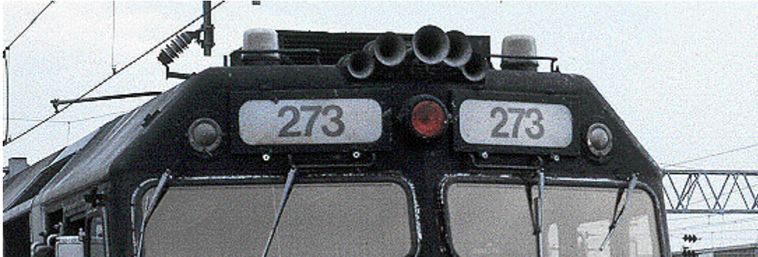
Figure C.1 Configuration des feux à éclats sur une locomotive Amtrak
