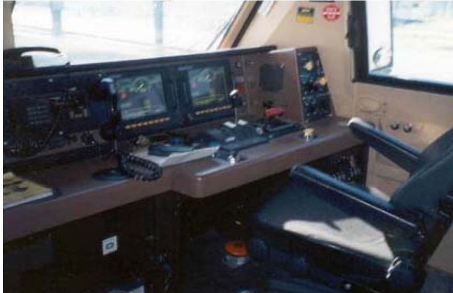
Figure 6 : Poste de conduite du mécanicien principal avec toutes les commandes de conduite et deux écrans pour l'affichage des paramètres des moteurs
