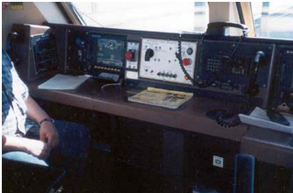
Figure 7 : Poste du co-mécanicien avec un seul écran, quelques commandes, un téléphone cellulaire et un radiotéléphone
