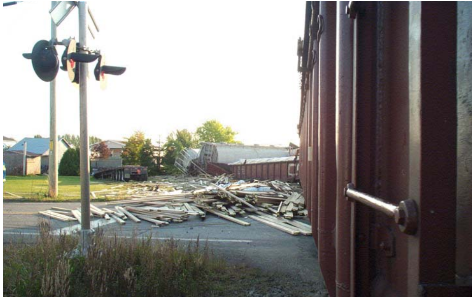
Figure 1 : Conséquences d'une collision avec un véhicule à un passage à niveau
