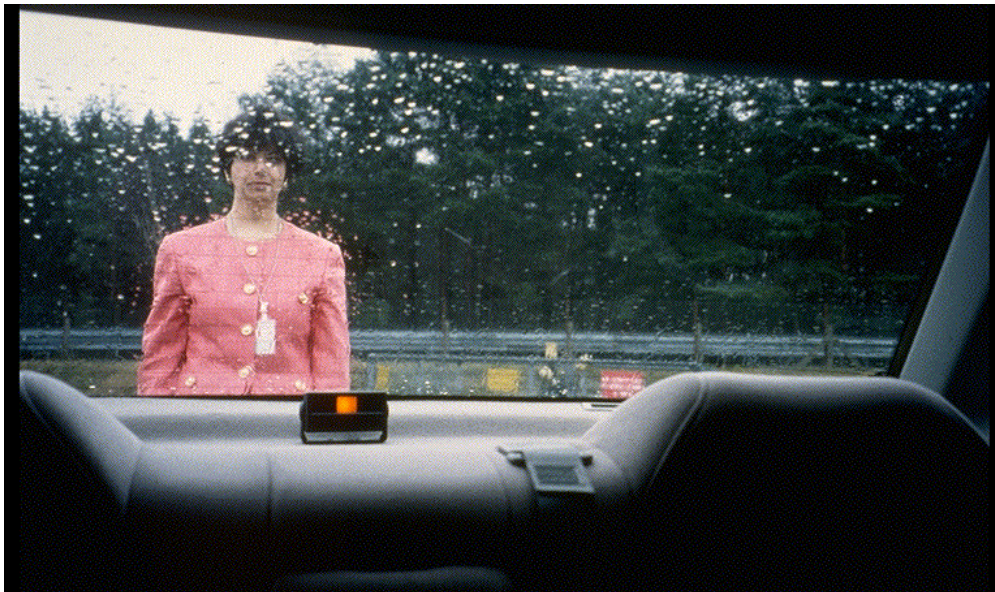
Figure 17 Détection d'obstacles. La boîte placée sur la plage de custode arrière montre un feu vert, jaune, rouge ou rouge clignotant selon la distance séparant la voiture de l'obstacle le plus proche situé à l'arrière.
