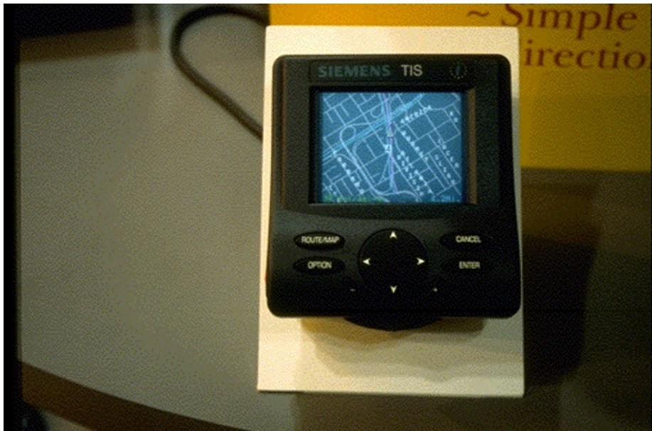
Figure 14b Système de navigation routière embarqué TIS de Siemens où l'affichage se fait sous forme cartographique et non sous forme schématique comme à la figure 7
