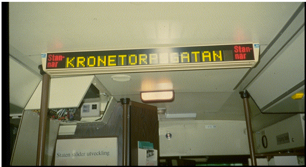
Figure 10 Affichage des arrêts successifs dans un autobus à Malmö en Suède. Les arrêts successifs sont annoncés en temps réel, grâce à un système de localisation de véhicules. Le signal rouge de chaque côté de l'arrêt annoncé signifie qu'un arrêt a été demandé.
