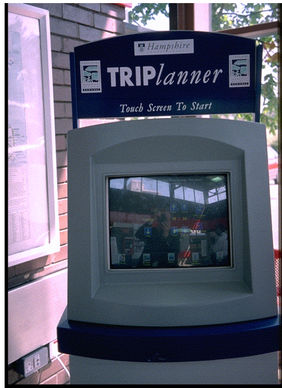
Figure 8 Terminal d'information pour la préparation d'un déplacement. Illustration d'un terminal permettant de préparer un déplacement multimode, implanté dans la gare centrale de Southampton en Grande-Bretagne. Commandé par boutons tactiles, il informe sur les transports par autocars, avions, chemins de fer et traversiers. Il indique le meilleur itinéraire entre une origine et une destination sélectionnées pour un déplacement par transports en commun ou par voiture privée. Il donne également des informations détaillées concernant un itinéraire donné.
