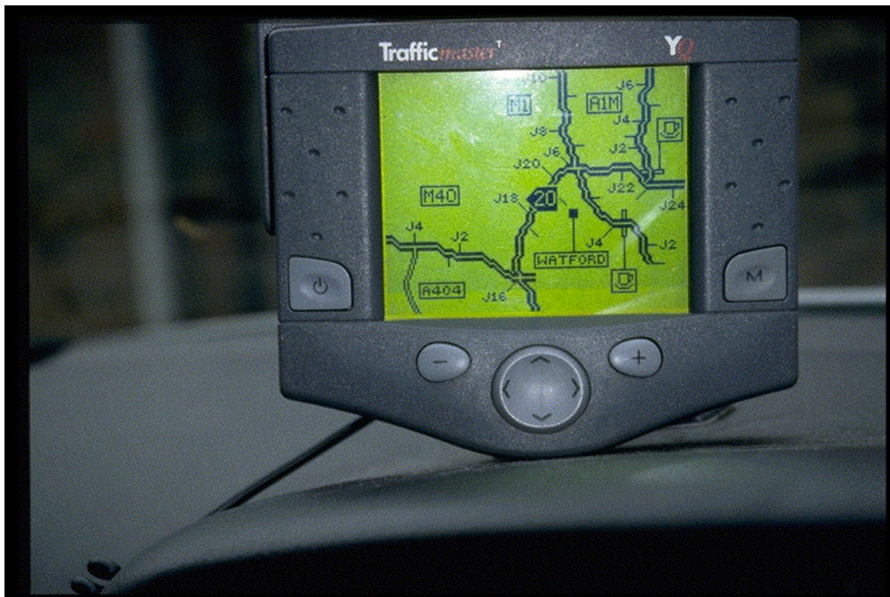
Figure 6 Le Trafficmaster informe en temps réel sur l'état de la circulation autoroutière en Grande-Bretagne. Il affiche en temps réel la vitesse de la circulation aux tronçons de l'autoroute où elle est tombée au-dessous de 30 mi/h. On voit ici le coin nord-ouest de l'autoroute périphérique M 25. Le chiffre 20 sur la flèche indique que la circulation dans la direction de la flèche avance à la vitesse moyenne de 20 mi/h depuis les trois dernières minutes. Il est possible d'éliminer cette indication. Utilisé en portatif, le système a une autonomie d'environ 8 heures.
