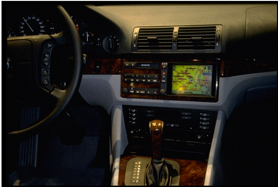
Figure 14a Système de navigation routière embarqué Carin de Philips, accessoire maintenant standard sur les voitures BMW séries 5 et 7
