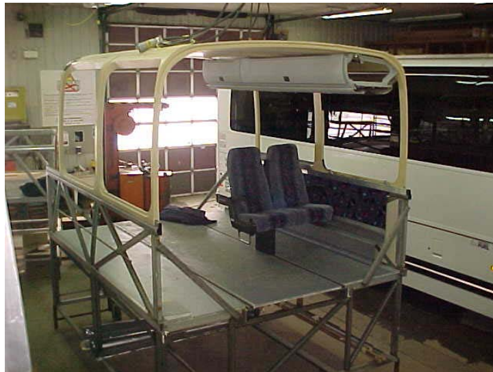
FIGURE 7 : Installation dans une maquette du module de toit à montants intégrés en composite
