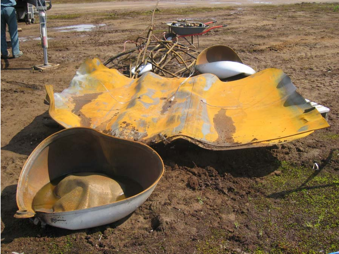
Figure 4.7: BLEVED tank, Test 04-1
