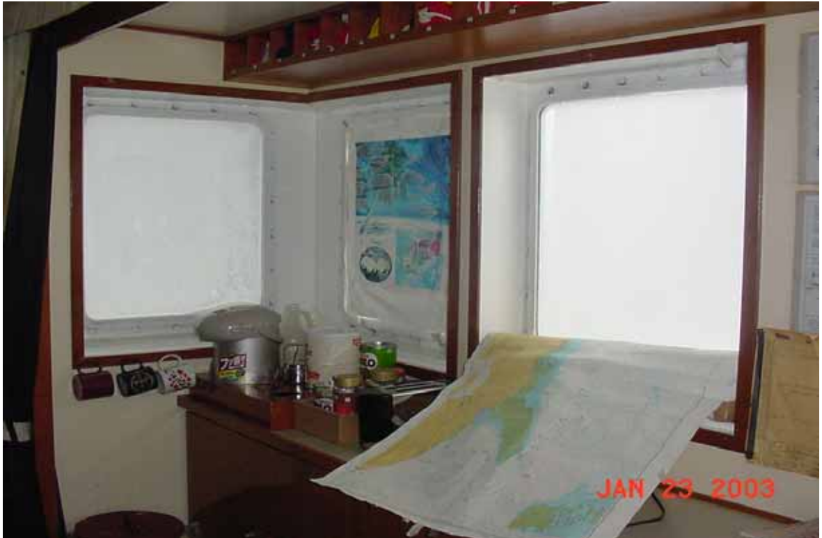
Figure 9.1A – Cartes de navigation utilisées comme isolant
