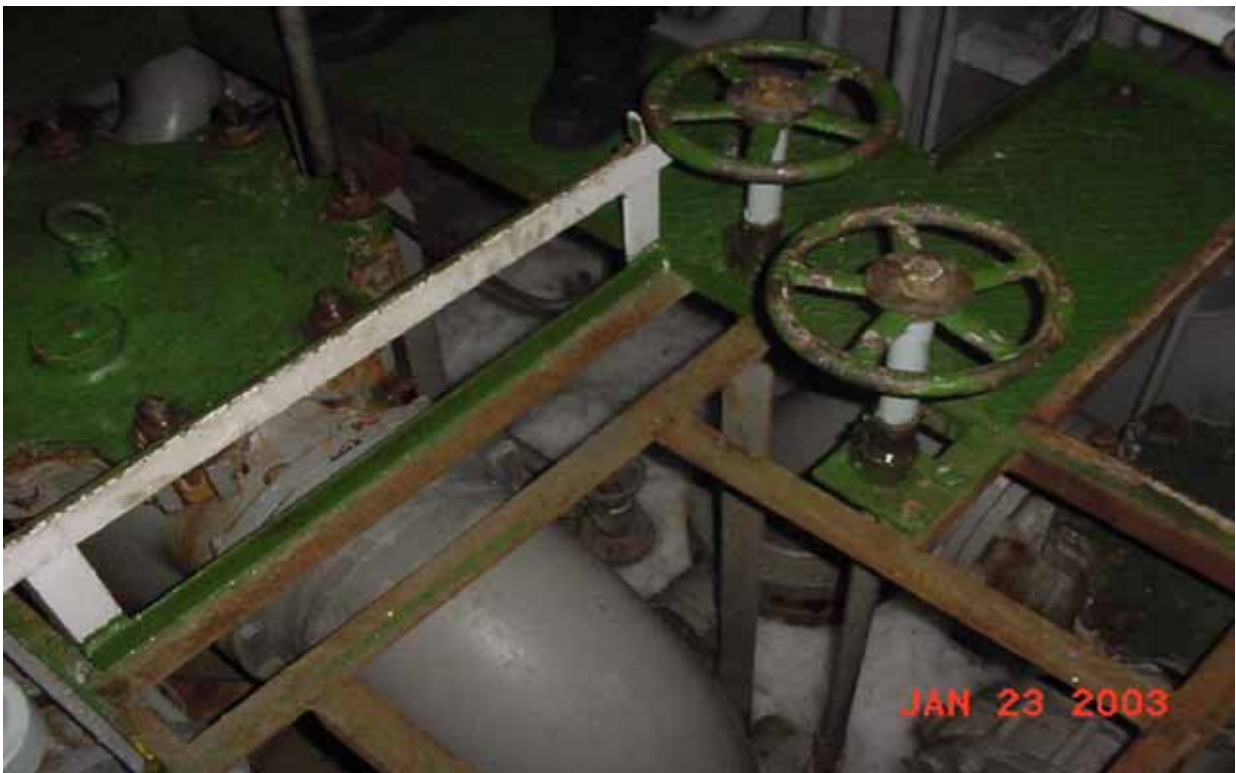
Figures 3.7B – Accumulation de glace dans les fonds attribable au nettoyage des crépines
