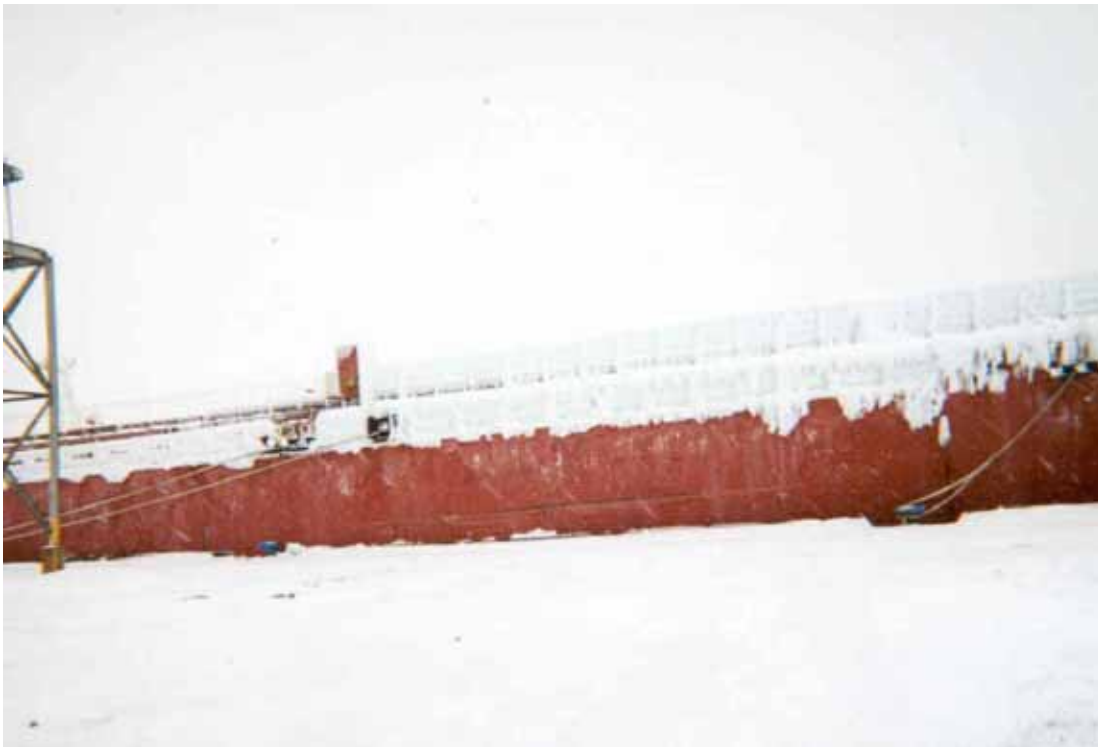
Figures 5.3B – Partie centrale du pont entièrement recouverte de glace
