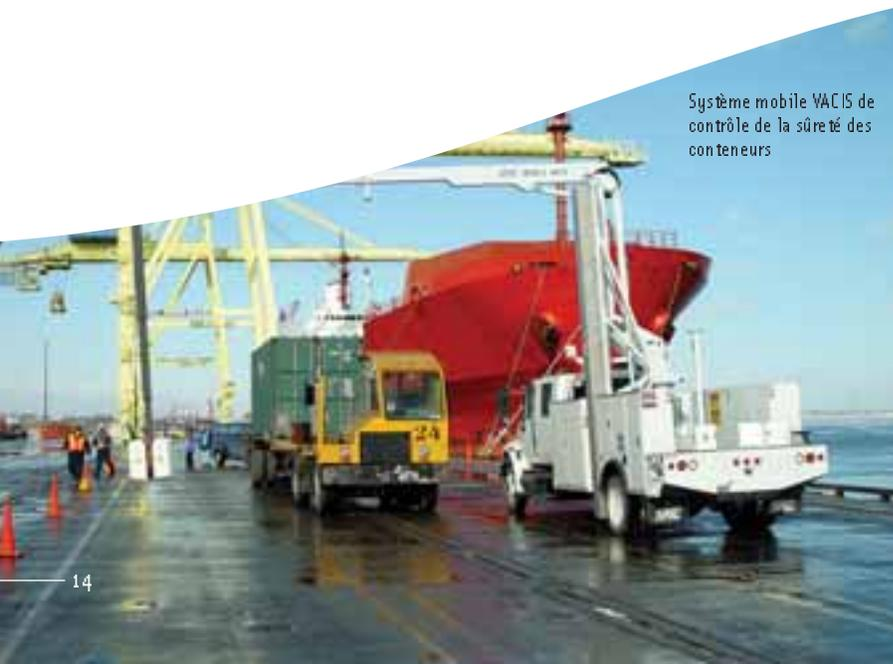
Système mobile VACIS de contrôle de la sûreté des conteneurs
