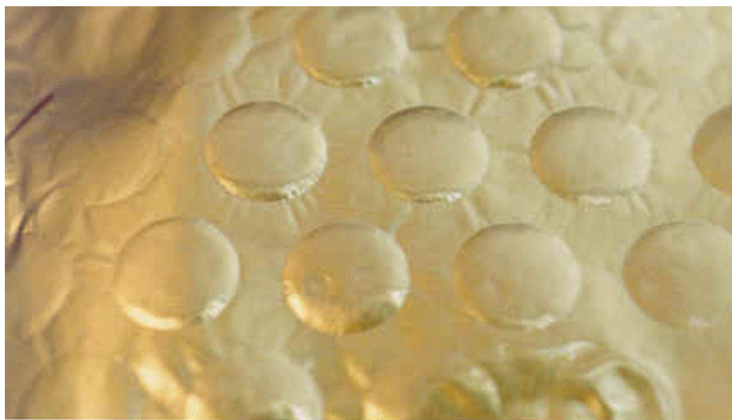
Photo de près de l'empreinte sur la surface du corps du sachet - Gaufrage
