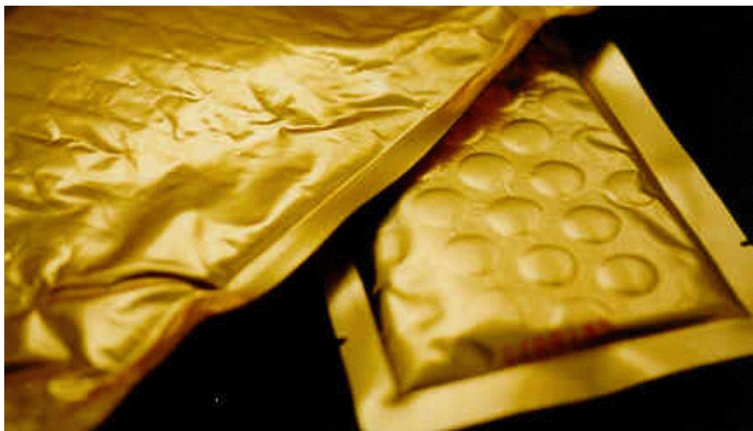
Empreinte du motif du casier de l'autoclave sur le corps du sachet
