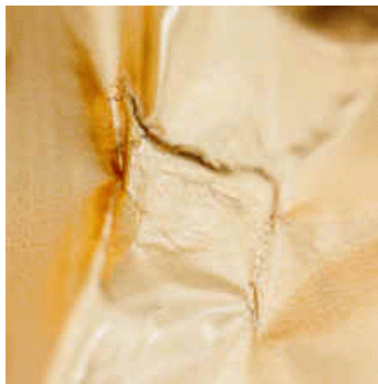
Vue latérale de la séparation des couches dans la zone de l'encoche
