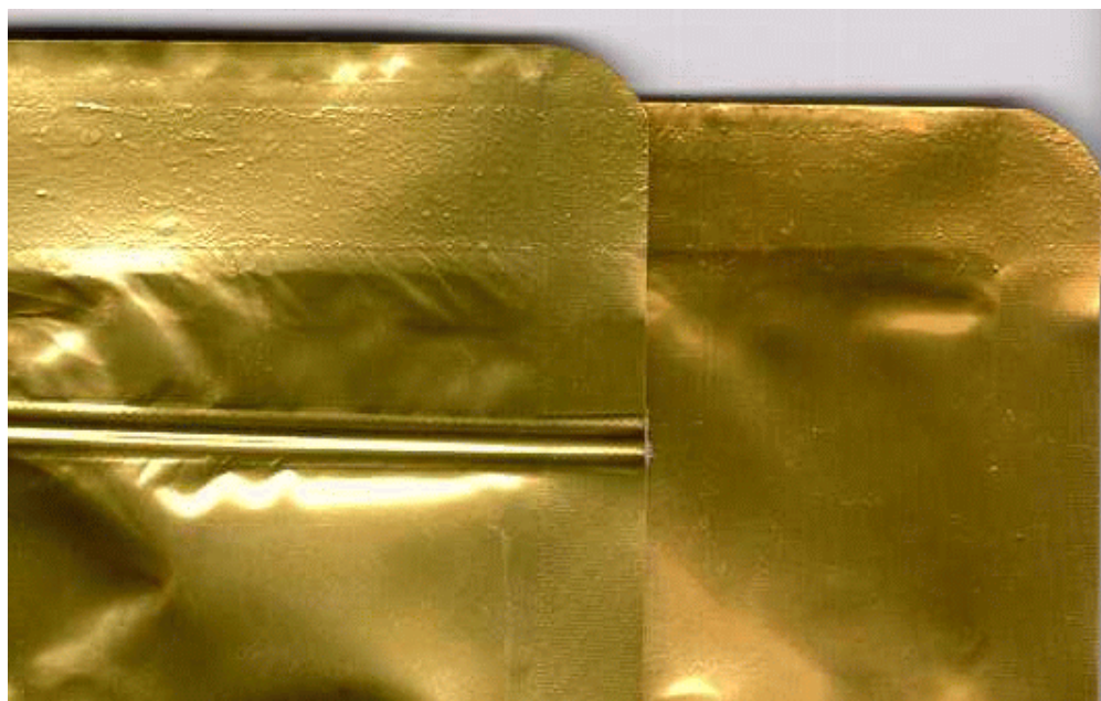
Sachet sur la gauche avec les jointes principal et cosmétique; sachet sur la droite avec joint cosmétique seulement
