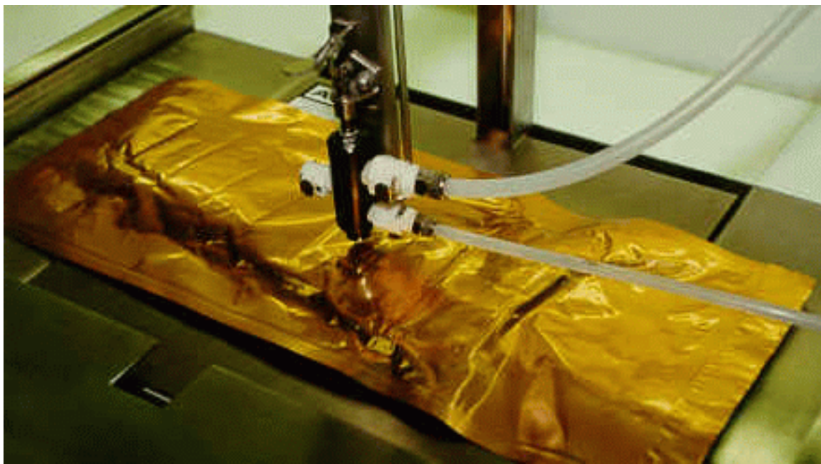
Figure 4.3 Appareil d'essai d'éclatement sous pression interne - mise à l'épreuve de 4 soudures Les sachets sont immobilisés entre deux plaques, illustrées en position ouverte (schéma supérieur)
