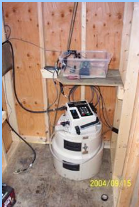
Échantillonneur automatique et enregistreur de données dans l'abri.
