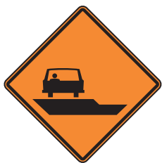
Signal avancé d'accotement surbaissé. Différence de hauteur due aux travaux
