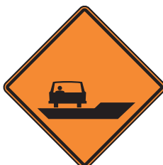
Signal avancé d'accotement surélevé. Différence de hauteur due aux travaux
