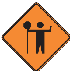
Signal avancé d'un signaleur
