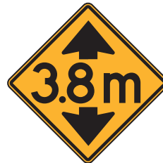
Hauteur limitée. Signal avancé de passage inférieur
