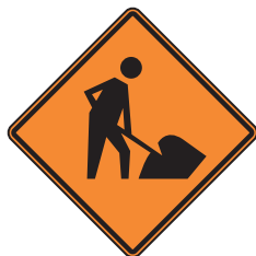
Signal avancé de travaux routiers
