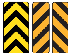
Signaux de danger. Les lignes vers le bas indiquent la direction à suivre.
