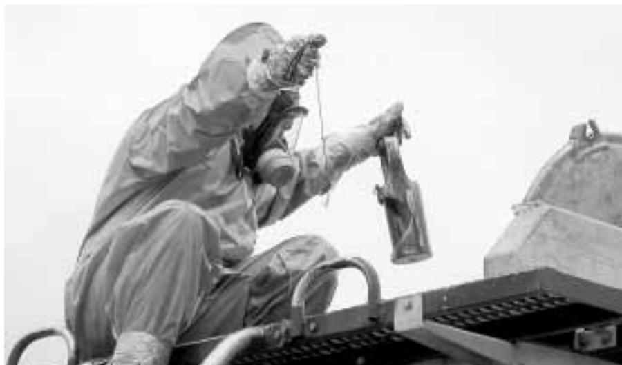
L'échantillonneur à bouteille lestée permet de prélever des échantillons dans des réservoirs de stockage, des puits, des puisards et d'autres réservoirs qui ne peuvent être convenablement échantillonnés avec un autre dispositif. On peut fabriquer ce type d'échantillonneur ou l'acheter.
