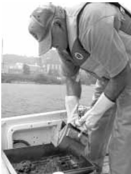
L'échantillonneur de grains est utilisé pour le prélèvement d'échantillons de déchets
