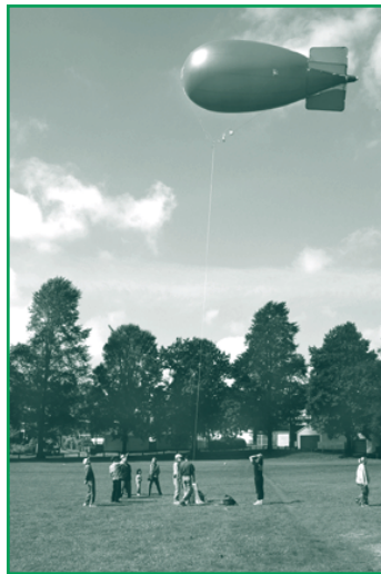
Ballon-sonde captif au site de Slokan, à Burnaby. Le ballon a été lâché jusqu'à une hauteur d'un kilomètre environ, puis ramené au sol à l'aide d'un treuil, pour permettre l'obtention d'un profil vertical de l'ozone et de paramètres météorologiques tels que la vitesse et la direction du vent, l'humidité et la température.
