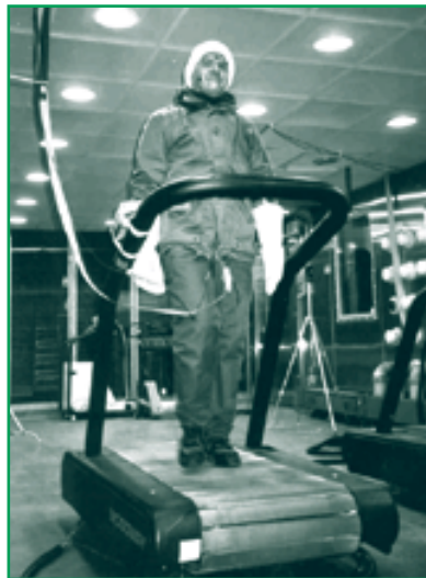
Des bénévoles munis de fluxmètres thermiques et de thermocouples ont participé à quatre tests d'une durée de 90 minutes chacun, effectués à des températures et à des vitesses de vent différentes à l'intérieur d'une soufflerie réfrigérée.
