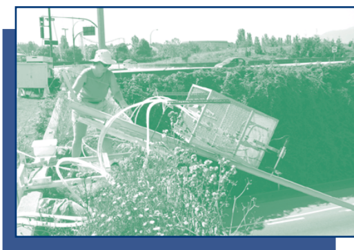
Une scientifique du Centre de technologie environnementale d'Environnement Canada abaisse un appareil de prélèvement d'air du pont routier qui surplombe le tunnel Cassiar, à Vancouver.
