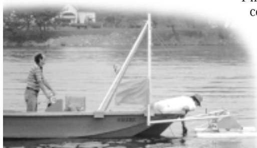
Échantillonnage de la microcouche superficielle de l'eau à la recherche de TBT
