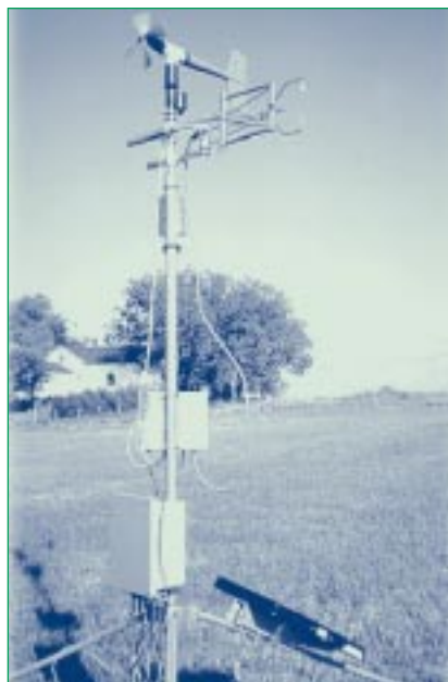
Matériel de surveillance utilisé pour mesurer les flux toxiques entre le sol et l'air.
