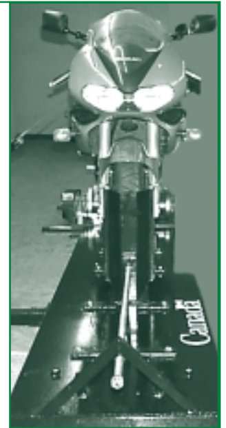
Une motocyclette montée sur un dynamomètre subit des tests d'émissions au Centre de technologie environnementale d'Ottawa.
