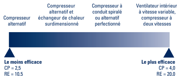
Figure 9 : Rendement des pompes géothermiques à circuit fermé (température de la solution antigel à l'entrée : 0°C)
