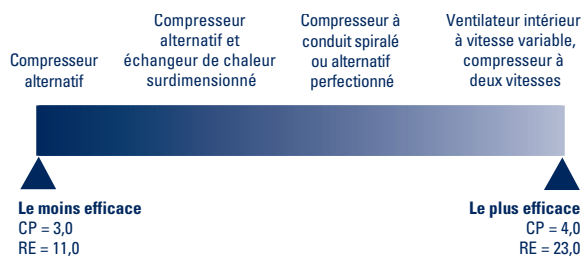
Figure 9 : Rendement des pompes géothermiques à circuit fermé (température de la solution antigel à l'entrée : 0°C)
