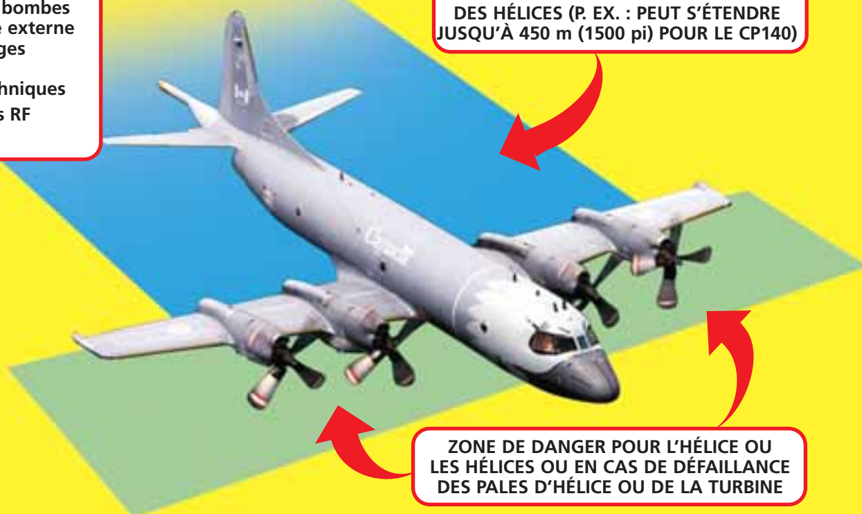
FIGURE 2 : Zones de dangers les plus importantes ou typiques pour les aéronefs avec une ou plusieurs hélices
