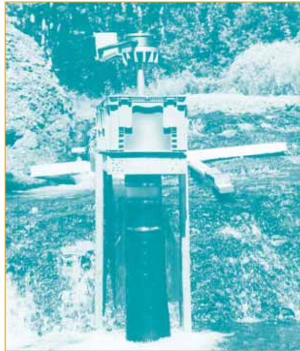
Figure 23. Système de 1 kW à accumulateurs et à faible hauteur de chute (photo – gracieuseté de Energy Systems & Design)
