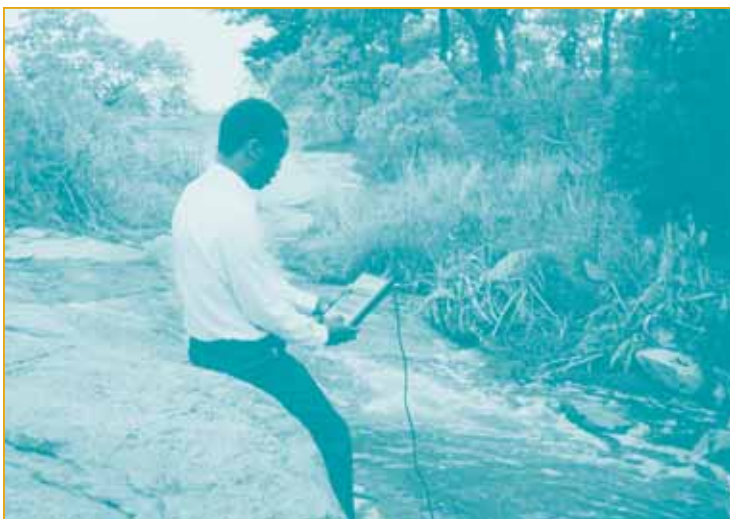
Figure 37. Mesure du débit à l'aide d'un conductivimètre intégrateur (photo – gracieuseté de Dulas Engineering Ltd.)
