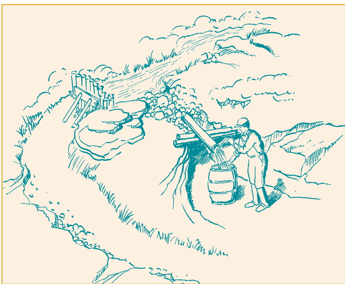
Figure 35. Mesure du débit à l'aide d'un contenant
