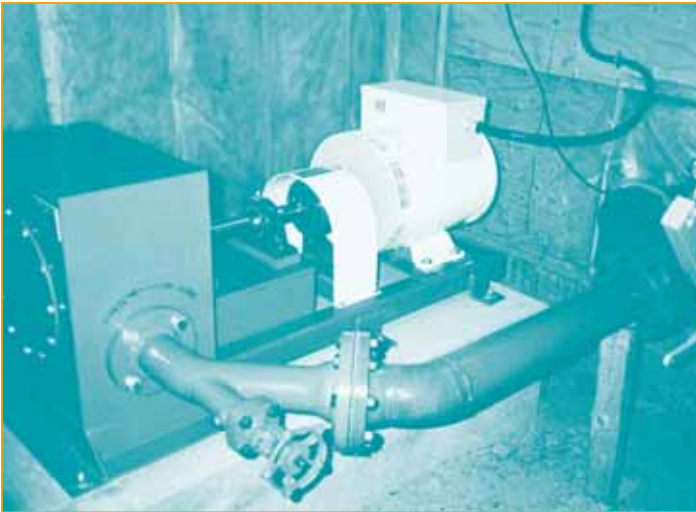
Figure 19. Turbine Pelton directement couplée à une génératrice synchrone de 8 kW
