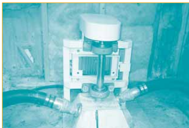
Figure 26. Système asynchrone à turbine Turgo à double jet, d'une puissance nominale de 5 kW
